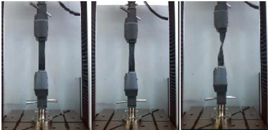
Εικόνα 64: Προσθευτικές απόψεις δοκιμής εφελκυσμού σε μονοστρωματικό δοκίμιο εποξικής ρητίνης με προσθήκη νανοδομών γραφενίου και ενίσχυση υαλοϋφάσματος.
