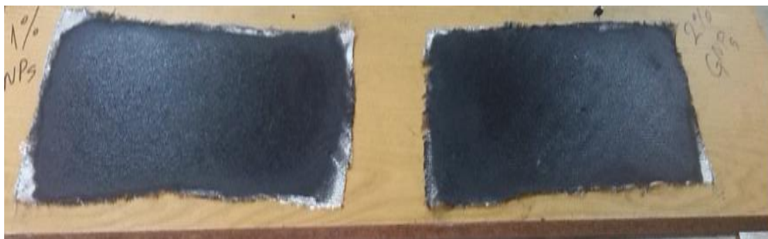
Εικόνα 60: Μονοστρωματικά σύνθετα υλικά υαλοϋφάσματος, εμποτισμένα με μίγμα εποξικής ρητίνης και προσθηκών γραφενικών νανοδομών, τοποθετημένα σε ξύλινη επιφάνεια.
