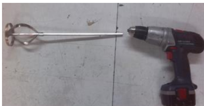
Εικόνα 59: Εργαστηριακός αναδευτήρας με μύτη ανάδευσης.
