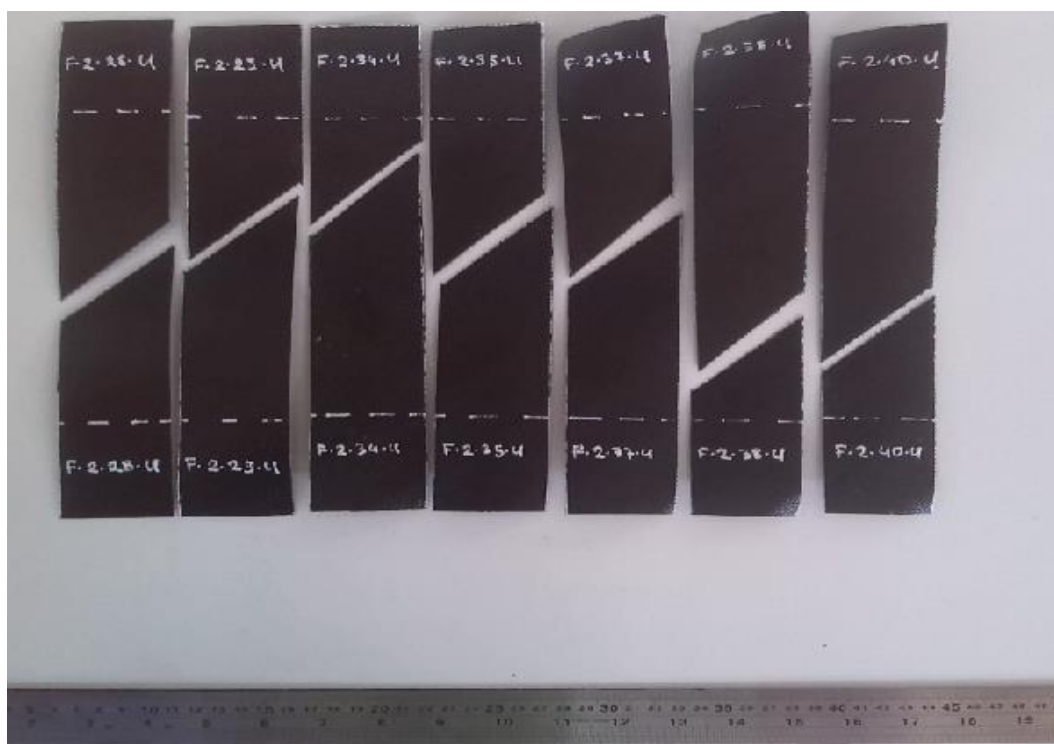
Εικόνα 67: Δοκίμια εποξικής ρητίνης/υαλοϋφάσματος 2% w.t. GNPs που έχουν υποστεί δοκιμή εφελκυσμού, κατόπιν επίδρασης δευτερογενούς θερμικής θεραπείας (post-curing).
