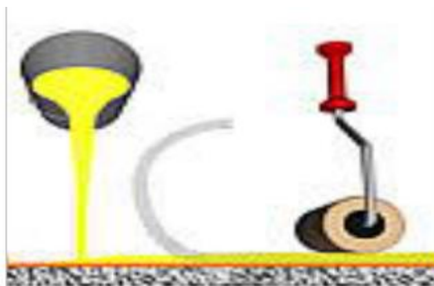
Εικόνα 35: Μέθοδος επίστρωσης με το χέρι (Hand lay-up)
