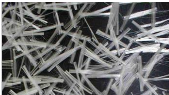
Εικόνα 15: Ίνες γυαλιού τύπου E
