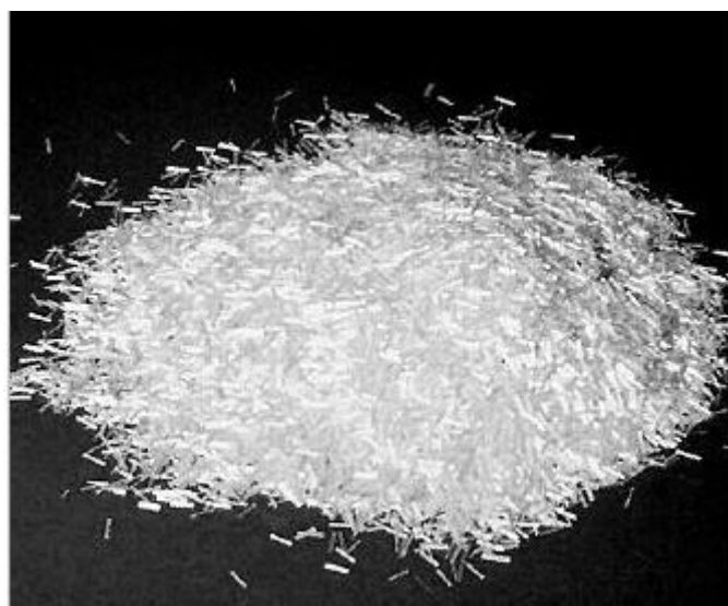
Εικόνα 17: Ίνες γυαλιού τύπου S
