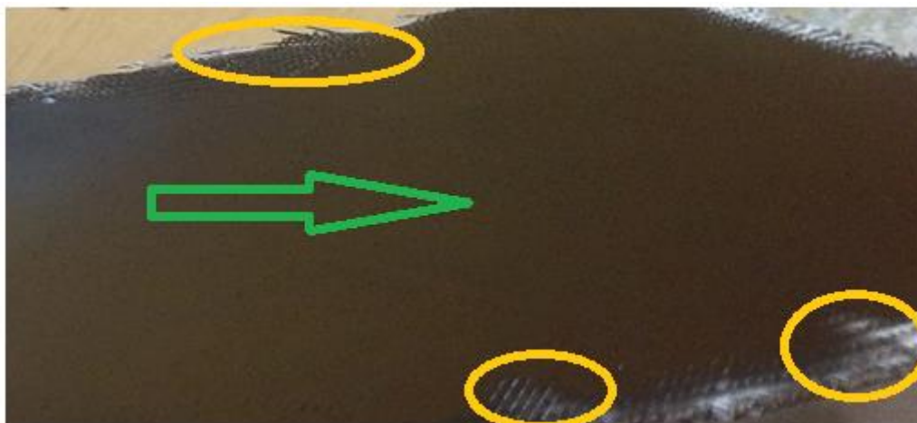
Εικόνα 61: Περιοχή ποιοτικά καλού εμποτισμού (βέλος) - Περιοχές μη ποιοτικά σωστού εμποτισμού (κύκλοι).
