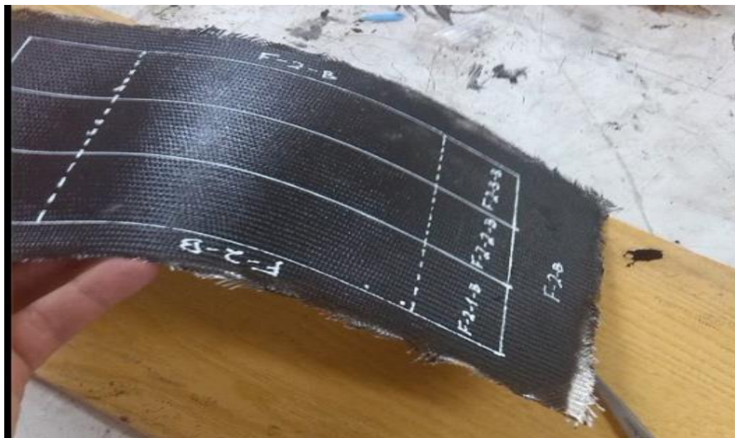
Εικόνα 62: Σχεδιασμός επιφάνειας μονοστρωματικού σύνθετου υλικού για την τελική κοπή δοκιμίων στις κατάλληλες διαστάσεις.
