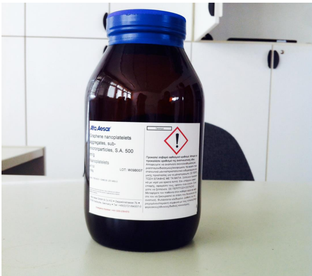
Εικόνα 53: Νανοδομές γραφενίου- Alfa Aesar™ Graphene nanoplatelets aggregates, sub-micronparticles, S.A. 500m 2 /g
