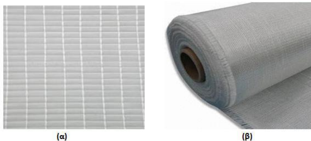
Εικόνα 23: (α) Υφή μονοδιευθυντικού υφάσματος-(β) Συσκευασία μονοδιευθυντικού υφάσματος
