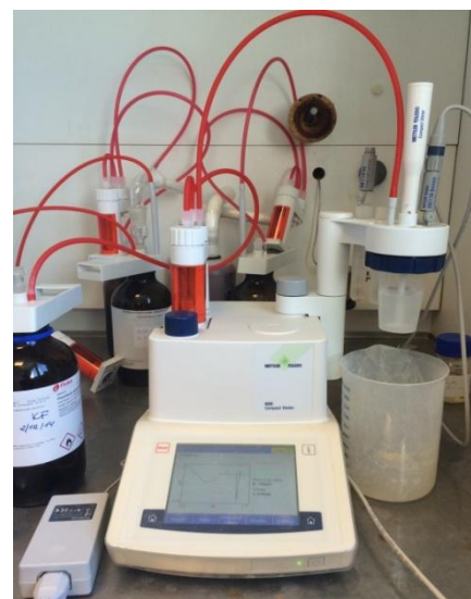
Εικόνα 12: Τιτλοδότης για τον προσδιορισμό του αριθμού αμινών.
