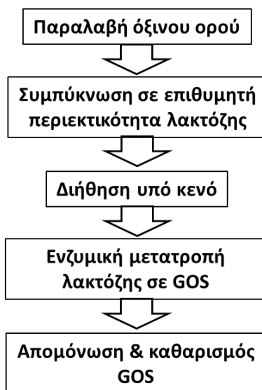
Εικόνα 21. Διάγραμμα ροής ενζυμικής μετατροπής της λακτόζης του όξινου ορού σε GOS με β-γαλακτοζιδάση από A. oryzae
