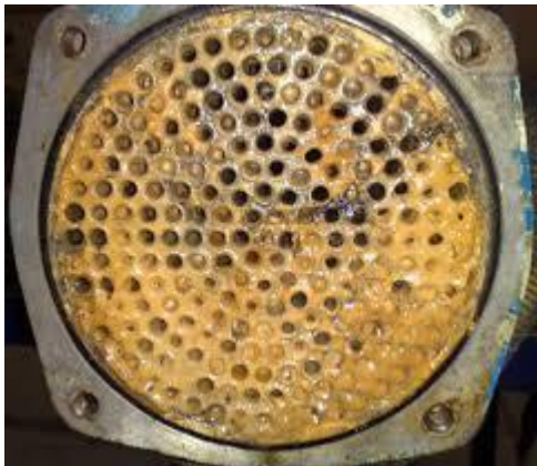
Εικόνα 3-17: Επικαθίσεις σε εναλλάκτη κελύφους-αυλών εσωτερικά και εξωτερικά των αυλών.
