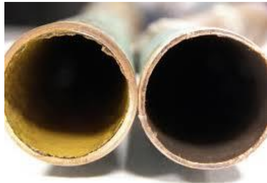
Εικόνα 3-17: Επικαθίσεις σε εναλλάκτη κελύφους-αυλών εσωτερικά και εξωτερικά των αυλών.
