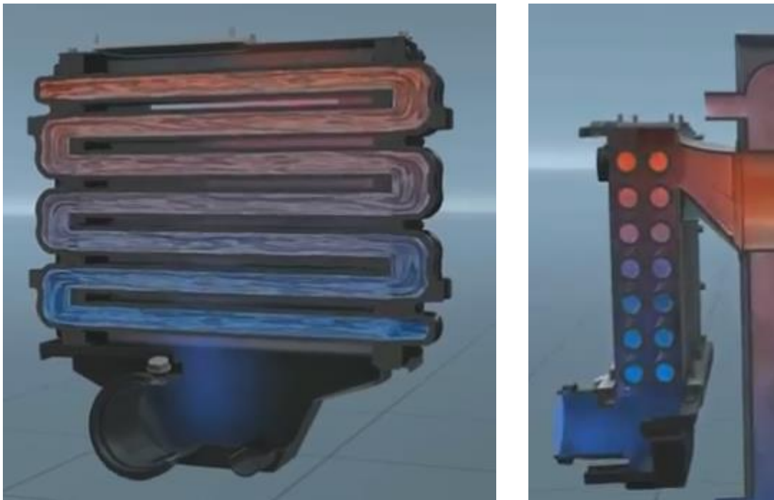
Εικόνα 2-1: Παράδειγμα εναλλάκτη κελύφους αυλών εγκάρσιας ροής (αριστερά) ροή ψυχρού νερού, (δεξιά) εμφανής η είσοδος των καυσαερίων στο άνω μέρος και η έξοδος τους στο κάτω (πηγή: BOMAT Heiztechnik GmbH).
