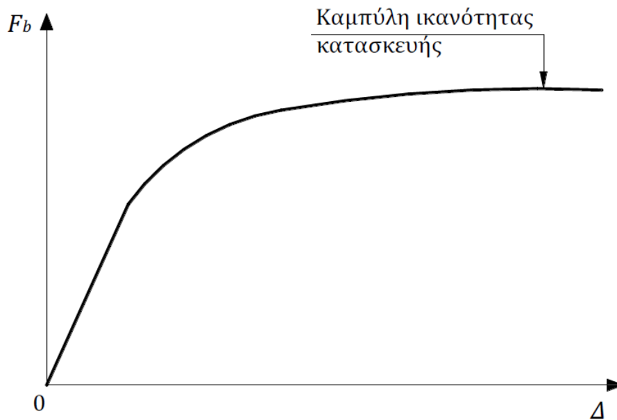
Σχ. 7.3: Χαρακτηριστική μορφή καμπύλης ικανότητας κατασκευής [13]
