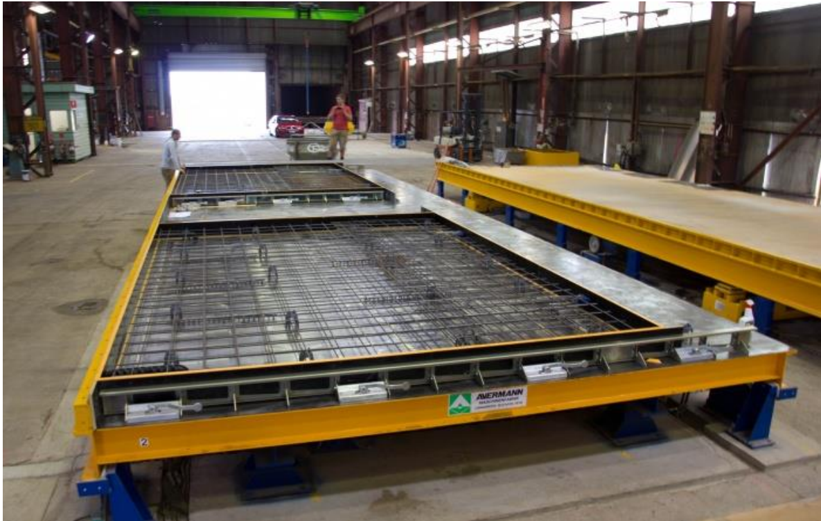
Σχ. 1.19: Διαδικασία κατασκευής πάνελου σε τύπο (καλούπι) στο εργοστάσιο
