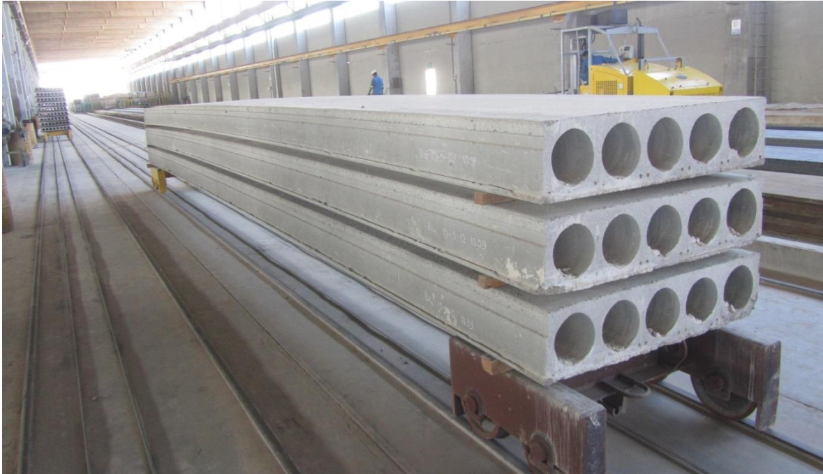
Σχ. 1.5: πλάκες με κοίλο πυρήνα στο εργοτάξιο
