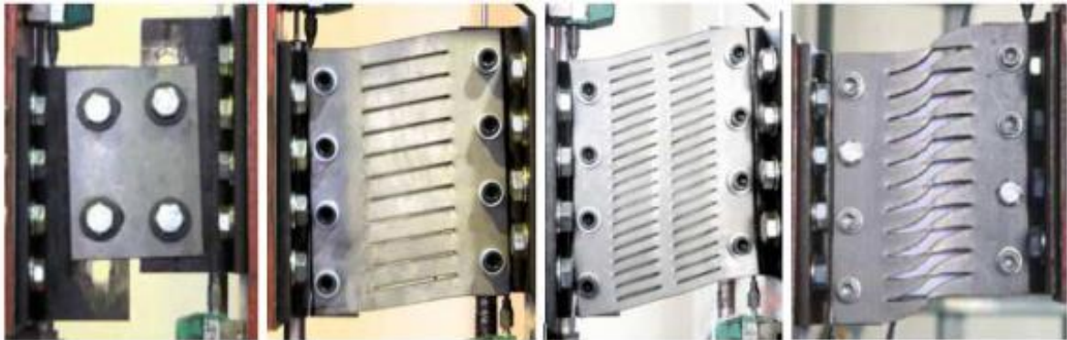
Σχ. 1.12: (α) συσκευή τριβής και (β,γ,δ) συσκευές πολλαπλών σχισμών [16]
