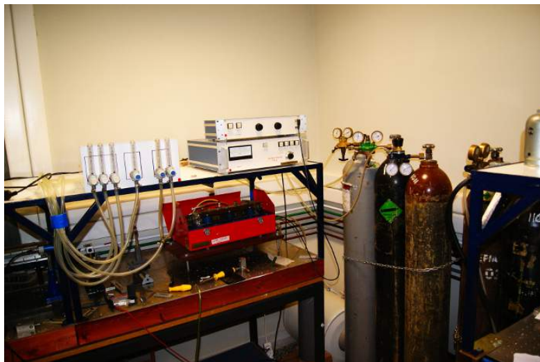
Εικόνα 11: Εργαστηριακό πρωτότυπο TEA: CO 2 laser.
