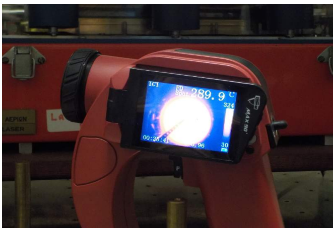
Εικόνα 22: Η θερμική κάμερα καταγραφής (ICI Toughcam EL S).
