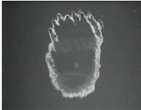
Εικόνα 63: Ακτινοβολήση με CO 2 laser, 10,6 μm, 38N, 77 mJ/mm 2 , 80 παλμοί.
