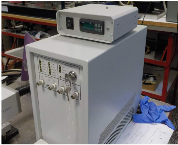
Εικόνα 8: Το τροφοδοτικό και ψυκτικό σύστημα της διάταξης.
