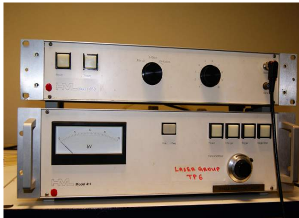
Εικόνα 14: Η παλμογεννήτρια των 300 Volt (πάνω) και η πηγή των 20.000 V(κάτω).
