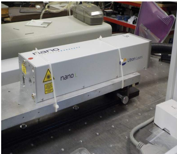
Εικόνα 7: Η κεφαλή του "Litron Nano L", Nd: YAG laser.
