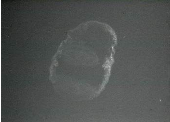
Εικόνα 62: Ακτινοβολήση με CO 2 laser, 10,6 μm, 38N, 77 mJ/mm 2 , 100 παλμοί.
