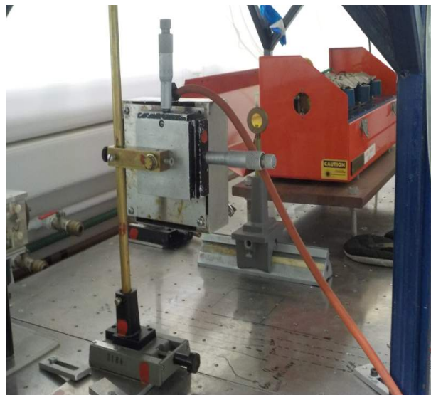
Εικόνα 19: Οπίσθια όψη θερμαντικής διάταξης. Διακρίνεται η 2-axial βάση της.
