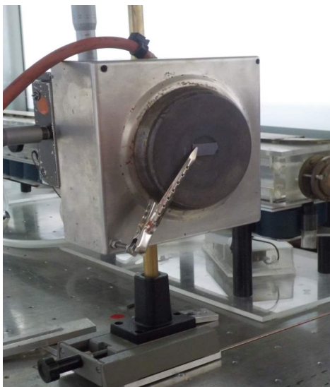
Εικόνα 20: Εμπρόσθια όψη θερμαντικής διάταξης. Διακρίνεται το κλίπ συγκράτησης και το δείγμα.
