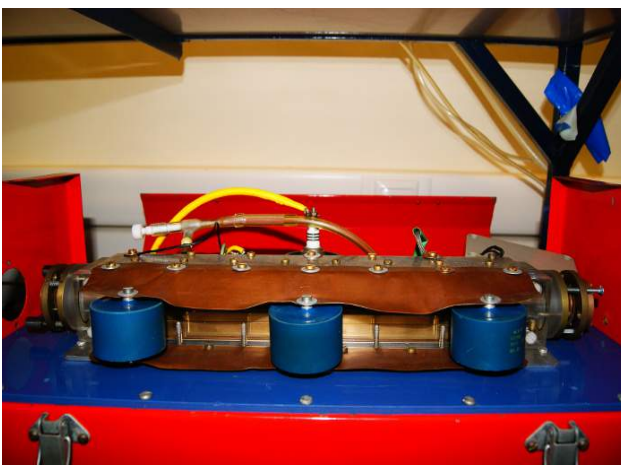
Εικόνα 12: Η κεφαλή του laser (οπτική κοιλότητα, άνοδος-κάθοδος, αντηχεία).
