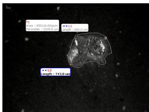
Εικόνα 54: Ακτινοβολήση με Nd:YAG laser, 1064 nm, SiO 2 , ενέργειας 25 mJ, εστία, 1 παλμός, δεδομένα.
