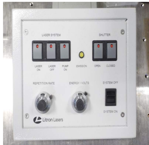
Εικόνα 9: Η κονσόλα ελέγχου του laser.
