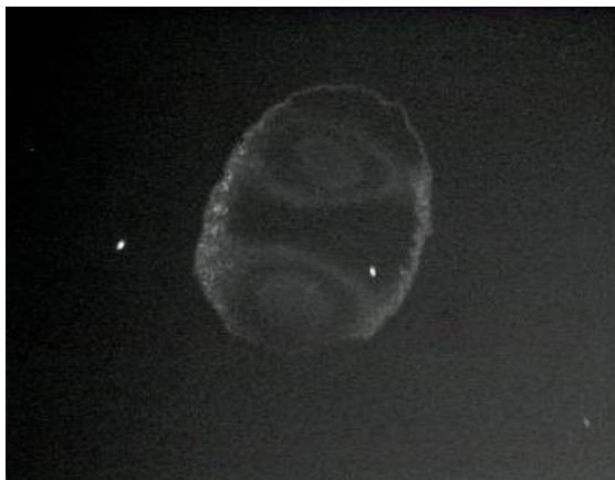
Εικόνα 71: Ακτινοβόληση με CO 2 laser, 10,6 μm, 38N, 77 mJ/mm 2 , 30 παλμοί.
