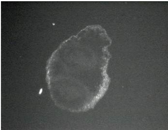
Εικόνα 65: Ακτινοβολήση με CO 2 laser, 10,6 μm, 38N, 77 mJ/mm 2 , 60 παλμοί.
