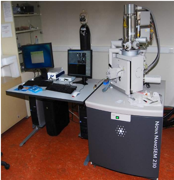
Εικόνα 89: Το ηλεκτρονικό μικροσκόπιο “Νοβα NanoSEM 230”, του Τομέα Φυσικής, Ε.Μ.Π. Διακρίνεται ο θάλαμος, το κυλινδρικό “πολυβόλο” ηλεκτρονίων ψηλά στη διάταξη, η αντλία και η κονσόλα χειρισμού.
