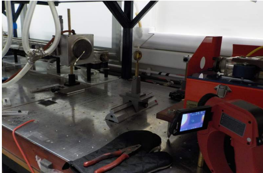
Εικόνα 18: Η διάταξη προθέρμανσης (αριστερά), ο φακός εστίασης, το laser και η θερμική κάμερα.
