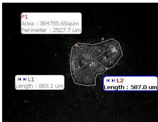
Εικόνα 51: Ακτινοβολήση με Nd:YAG laser, 1064 nm, SiO 2 , ενέργειας 50 mJ, εστία, 1 παλμός, δεδομένα.
