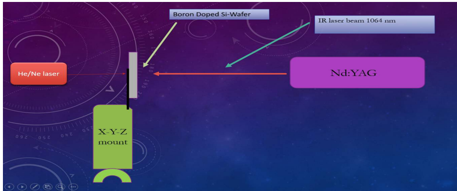
Εικόνα 5: Αναπαράσταση της διάταξης ακτινοβολήσης. Διακρίνεται η βάση στήριξης του δείγματος, ο φακός και η κεφαλή του laser.
