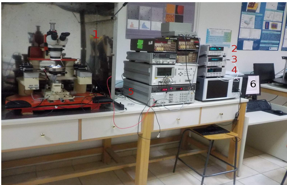
Εικόνα 177: Η συστοιχία των διατάξεων για τον ηλεκτρικό χαρακτηρισμό των δειγμάτων. Διακρίνεται ο σταθμός των ακίδων (1), η πηγή ρεύματος (2), το νανοβολτόμετρο (3), ο πολυπλέκτης (4), η συσκευή μεταφοράς δεδομένων (5) και ο ηλεκτρονικός υπολογιστής (6).
