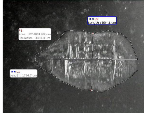
Εικόνα 58: Ακτινοβολήση με CO 2 laser, 10,6 μm, 38N, ενέργειας 116,6 mJ, εστία, 150 παλμοί, διαστάσεις.
