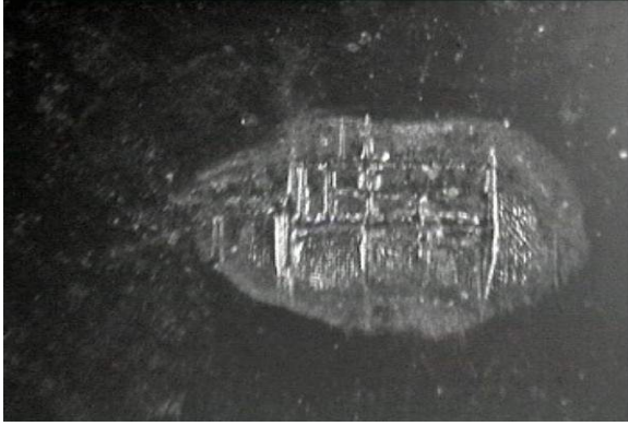
Εικόνα 57: Ακτινοβολήση με CO 2 laser, 10,6 μm, 38N, ενέργειας 116,6 mJ, εστία, 150 παλμοί.
