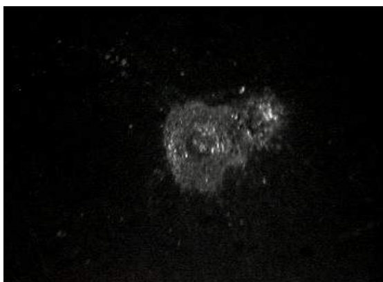
Εικόνα 52: Ακτινοβολήση με Nd:YAG laser, 1064 nm, SiO 2 , ενέργειας 50 mJ, εστία, 1 παλμός.
