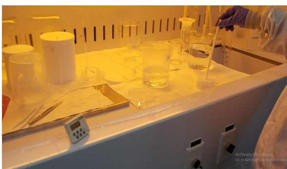
Εικόνα 25: Λεπτομέρεια χώρου καθαρισμού. Διακρίνονται τα δοχεία με το διάλυμα piranha, το ειδικό πιγκάλ και το χρονόμετρο.
