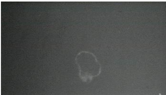
Εικόνα 75: Ακτινοβολήση με CO 2 laser, 10,6 μm, 38N, 77 mJ/mm 2 , 8 παλμοί
