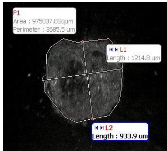
Εικόνα 46: Ακτινοβόληση με Nd:YAG laser, 1064 nm, SiO 2 , ενέργειας 150 mJ, εστία, 1 παλμός, διαστάσεις.
