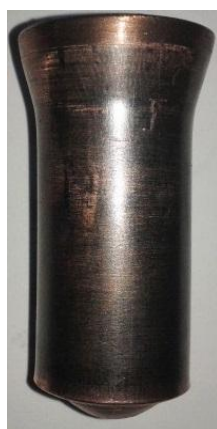
Εικόνα 3.27 : Δοκίμιο ονομαστικού πάχους 3.0 mm μετά τη διέλαση
