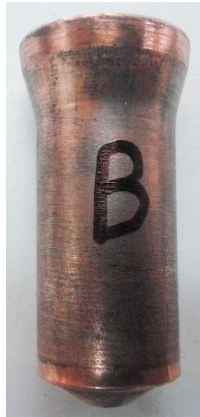
Εικόνα 3.41 : Δοκίμιο Β μετά το πρώτο στάδιο διέλασης
