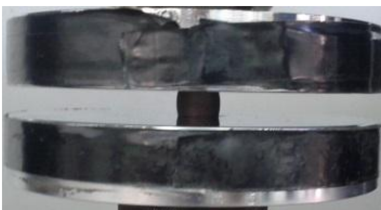
Εικόνα 3.20 : Στιγμιότυπο από την θλίψη του δοκιμίου Cu σε φορτίο 90 kN
