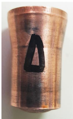
Εικόνα 3.47 : Δοκίμιο Δ μετά το δεύτερο στάδιο διέλασης
