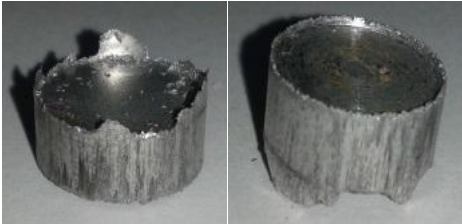
Εικόνα 3.22 : Προϊόν κονιομεταλλουργίας απο την συμπύεση της σκόνης Al 40+325
