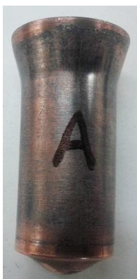
Εικόνα 3.39 : Δοκίμο A μετά το πρώτο στάδιο διέλασης
