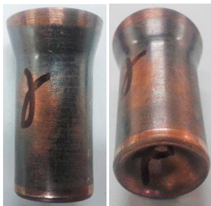
Εικόνα 3.25 : Δοκίμιο ονομαστικού πάχους 1.5 mm μετά τη διέλαση
