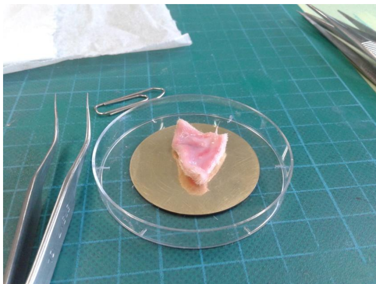
Εικόνα 18. Ιστός δέρματος αρουραίου τοποθετημένος στο κάτω ηλεκτρόδιο. Ένα δεύτερο ηλεκτρόδιο γνωστής διαμέτρου τοποθετείται από πάνω και σχηματίζεται ο πυκνωτής.
