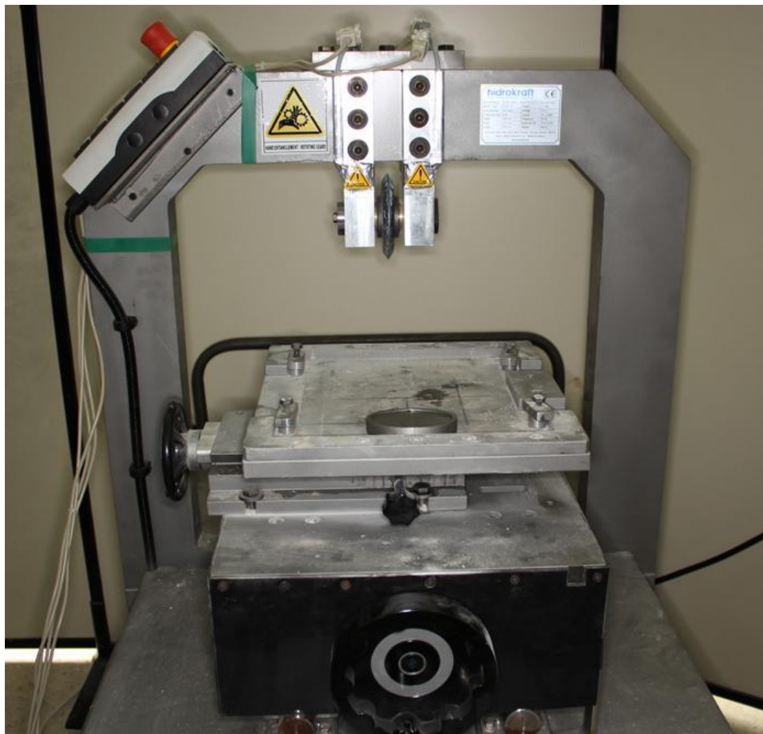
Σχήμα 6.3. Απεικόνιση του χρησιμοποιούμενου εξοπλισμού δοκιμής κοπής (Πηγή: Πατσίδης, 2012)
