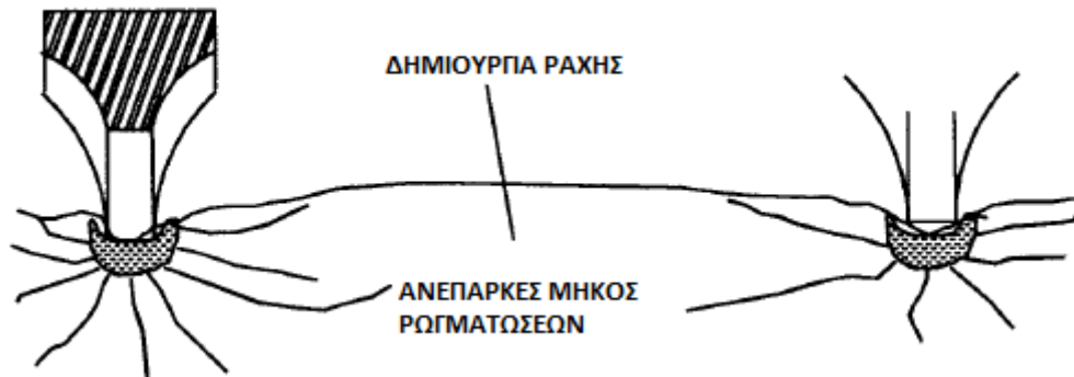
Σχήμα 2.18. Μη επαρκής απόσταση κοπτικών για δημιουργία θραύσματος (Πηγή: Rostami & Ozdemir, 1993)
