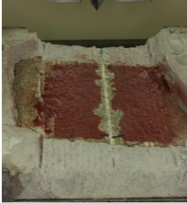
Σχήμα 6.6. Κοπή σχιστώδους ορθογενεσίου σε βάθος 2 mm // της σχιστότητας του πετρώματος (Πηγή: Πατσίδης, 2012)
