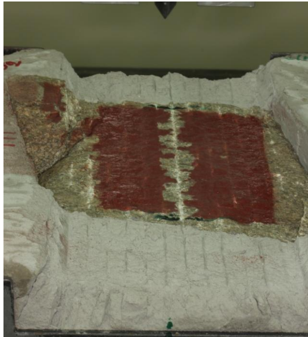
Σχήμα 6.7. Κοπή σχιστώδους ορθογενεσίου σε βάθος 2 mm \perp της σχιστότητας του πετρώματος (Πηγή: Πατσίδης, 2012)
