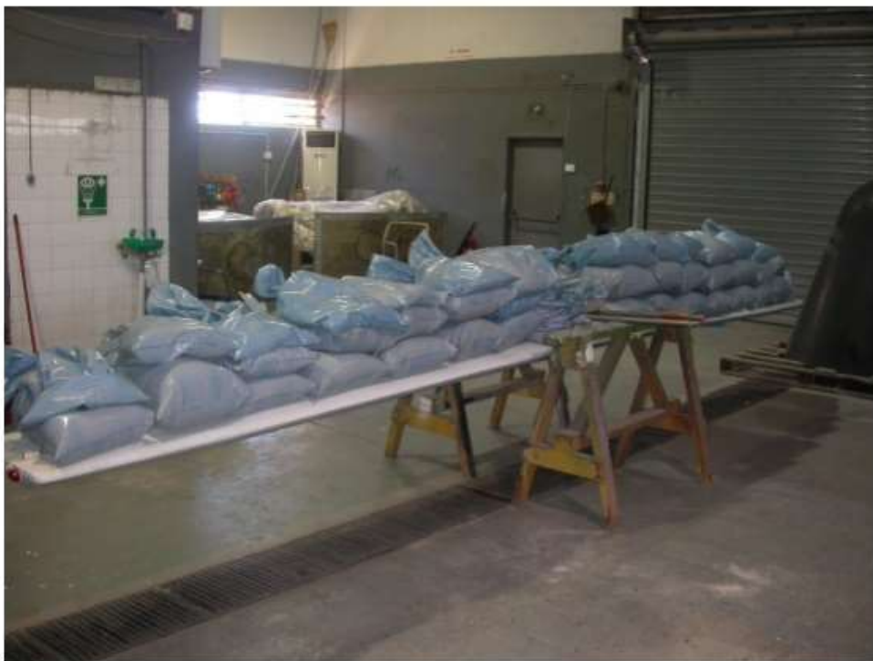
Εικόνα 6.3: Κατασκευή πτέρυγας με ελλειπτική φόρτιση
