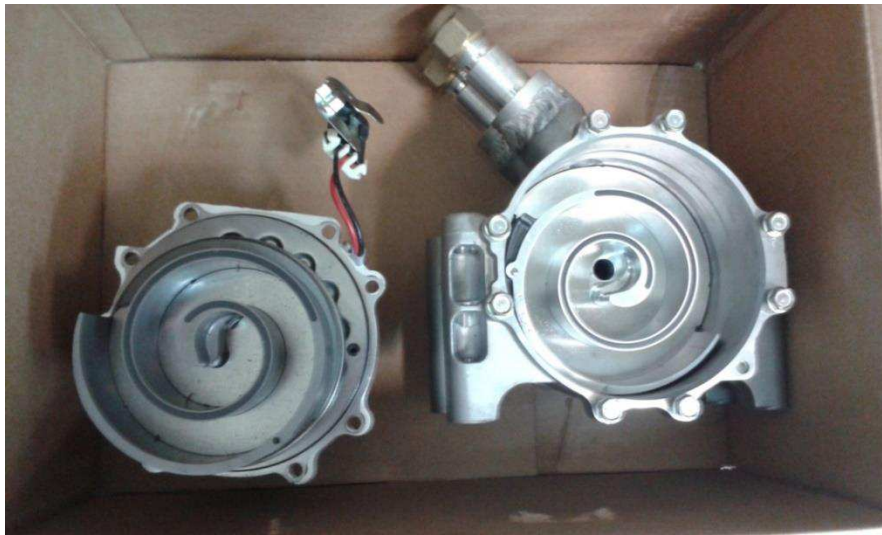
Εικ. 2.9. Κινητή (αριστερά) και σταθερή σπείρα εκτονωτή εγκατάστασης
