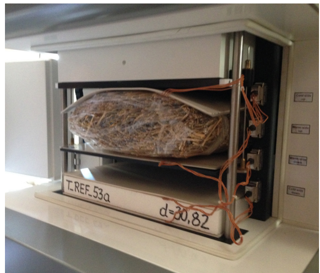
Εικόνα 4.3.2 Εισαγωγή δοκιμίου στο όργανο μέτρησης της θερμικής αγωγιμότητας
