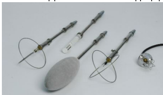
Εικόνα 3.2.1 Αισθητήρες Comfort Sense
