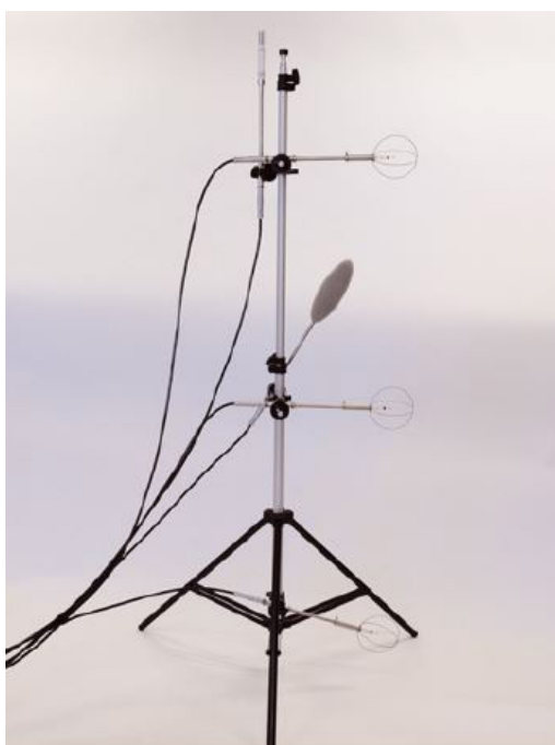
Εικόνα 3.2.3 Θέσεις αισθητήρων Comfort Sense κατά την μέτρηση
