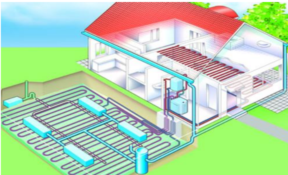
Εικόνα 1.6 Σύστημα γεωθερμίας με οριζόντιο γεωεναλλάκτη
