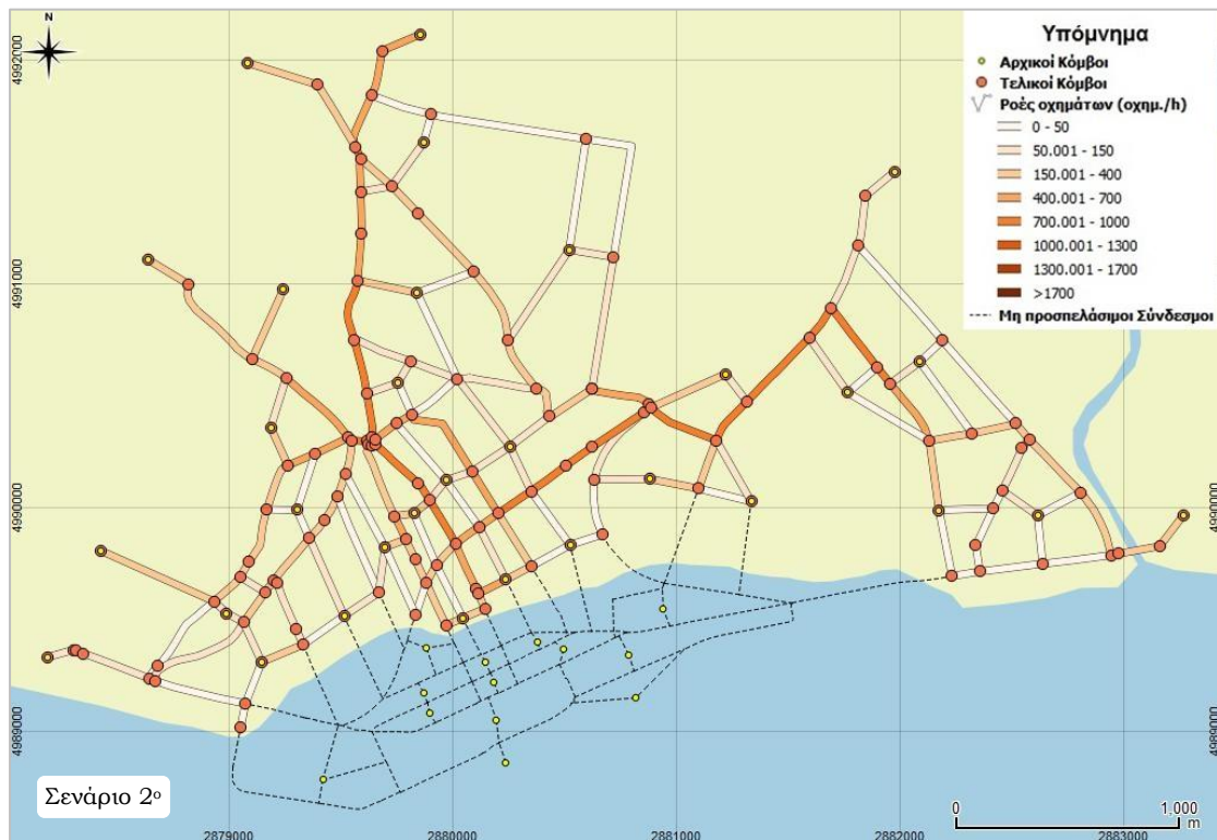
Εικόνα 18: Κατανομή κυκλοφοριακών ροών στο δεύτερο σενάριο. Οι ροές είναι χαμηλότερες στον άξονα βορρά-νότου ενώ αυξήθηκαν στον άξονα ανατολής-δύση. (Ιδία επεξεργασία)
