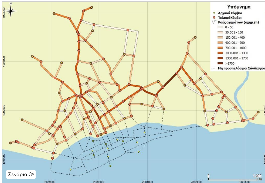
Εικόνα 21: Κατανομή κυκλοφοριακών ροών στο τρίτο σενάριο. Οι ροές παρουσιάζονται ιδιαίτερα αυξημένες σε σχέση με τα προηγούμενα σενάρια.
