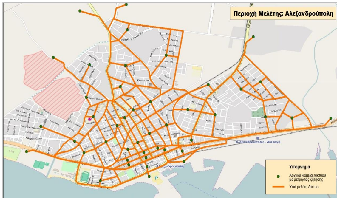
Εικόνα 11: Γραφική αναπαράσταση του δικτύου σε γεωδαιτικό σύστημα αναφοράς WGS84. Διαφαινόνται οι σύνδεσμοι του δικτύου, οι κόμβοι που καταγράφεται η ζήτηση. (Υπόβαθρο: Open Street Maps , 2016)
