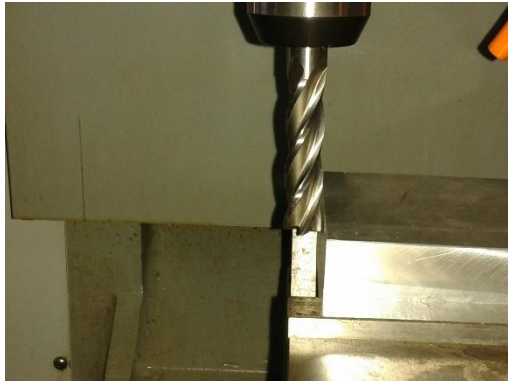
Εικόνα 2.15 Εύρεση αρχής άξονα X
