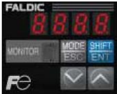
Σχήμα 3.6 Οθόνη ενδείξεων βαθμίδας ενίσχυσης
