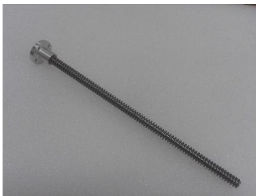
Εικόνα 2.50 Ο κοχλίας κατακόρυφης κίνησης με τη βάση του
