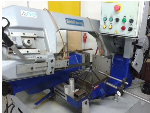
Εικόνα 2.2 Κορδέλα κοπής αρχικού stock
