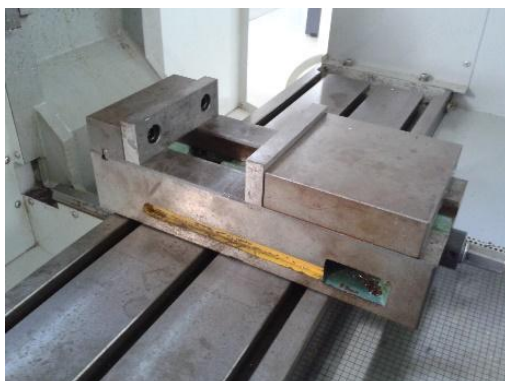
Εικόνα 2.8 Μέγγενη συγκράτησης κατεργαζόμενου τεμαχίου
