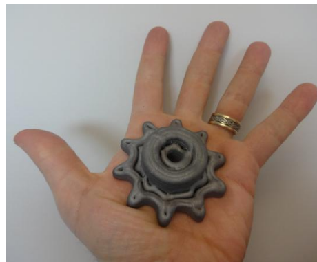
Εικόνα 1.3 Τρισδιάστατο γρανάζι εκτυπωμένο στη διάταξη.
