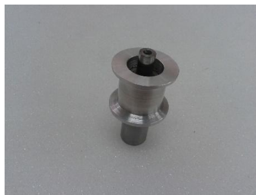
Εικόνα 2.60 Τροχαλία τάνυσης ιμάντα με τον άξονα
