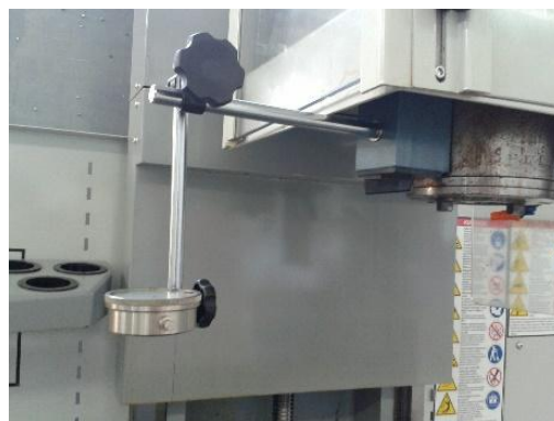
Εικόνα 2.10 Στήριξη ρολογιού στο Z άξονα
