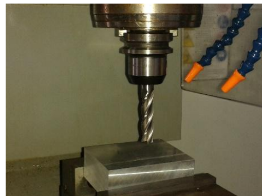
Εικόνα 2.14 Τεμάχιο μετά την κατεργασία με φρεζοκεφαλή
