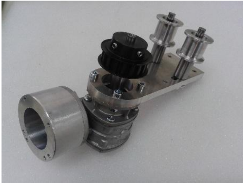
Εικόνα 2.61 Ο συναρμολογημένος μειωτήρας
