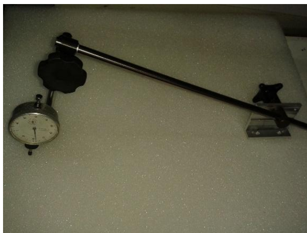
Εικόνα 6.1 Μετρητικό ρολόι με την αυτοσχέδια βάση
