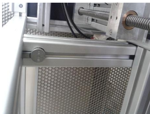
Εικόνα 2.63 Στήριξη του μηχανισμού εναπόθεσης σκόνης στο σώμα της μηχανής
