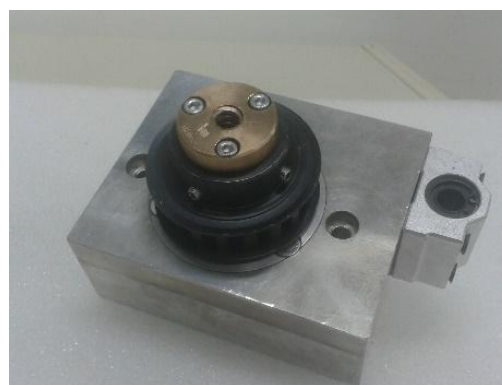
Εικόνα 2.49 Το σύστημα κατακόρυφης κίνησης συναρμολογημένο
