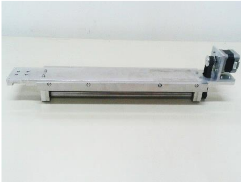
Εικόνα 2.31 Το συναρμολογημένο σύστημα εναπόθεσης σκόνης
