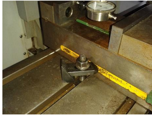
Εικόνα 2.12 Στερέωση μέγγενης με σφιγκτήρες
