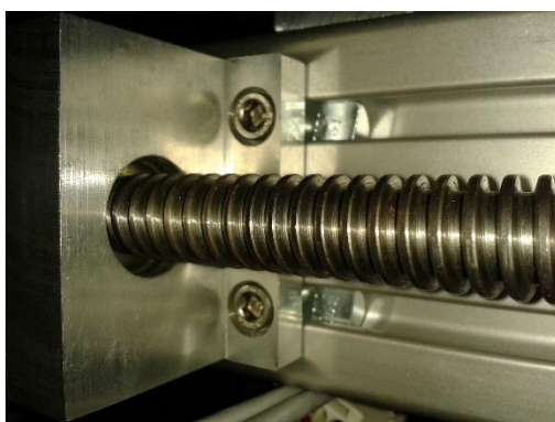
Εικόνα 2.42 Στερέωση ελεύθερης στήριξης κοχλία
