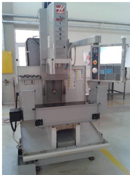
Εικόνα 2.7 Η φρέζα HAAS TM1
