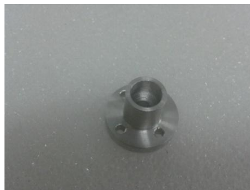
Εικόνα 2.52 Βάση γραμμικού οδηγού και κοχλία κίνησης
