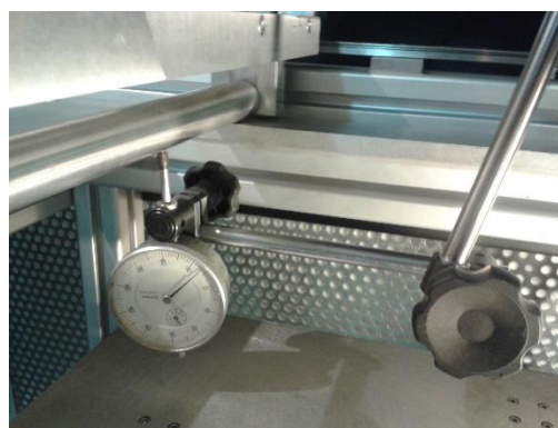
Εικόνα 6.9 Ευθυγράμμιση του ράουλου
