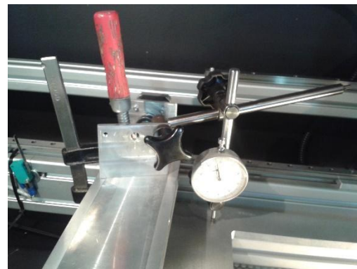
Εικόνα 6.12 Ευθυγράμμιση μηχανισμού εναπόθεσης σκόνης
