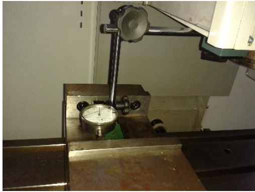
Εικόνα 2.11 Εύρεση απόκλισης μέγγενης
