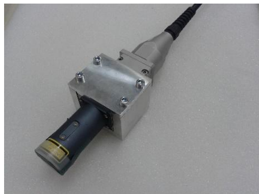
Εικόνα 2.75 Βάση με την κεφαλή laser
