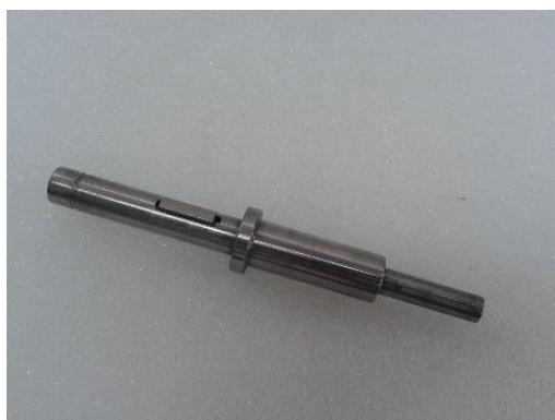
Εικόνα 2.57 Άξονας κινητήριας τροχαλίας
