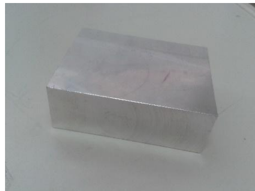
Εικόνα 2.6 Τεμάχιο μετά την κατεργασία με φρεζοκεφαλή
