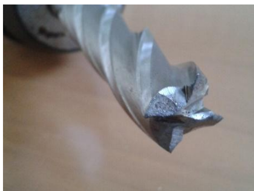
Εικόνα 2.18 Κονδύλι διαμέτρου 16mm, 4 δοντιών
