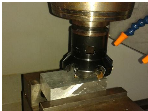
Εικόνα 2.13 Κατεργασία τεμαχίου με τη φρεζοκεφαλή
