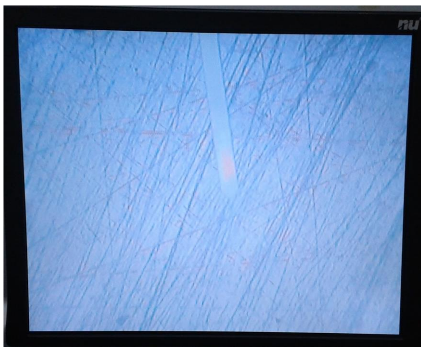
Εικόνα 4.12 Επιφάνεια δοκιμίου κατά τα ενδιάμεσα στάδια της κατεργασίας όπως γίνεται εμφανής μέσω της κάμερας CCD. Στην εικόνα διακρίνεται και ο μικροπρόβολος που φέρει την ακίδα σάρωσης στο πέρας του.
