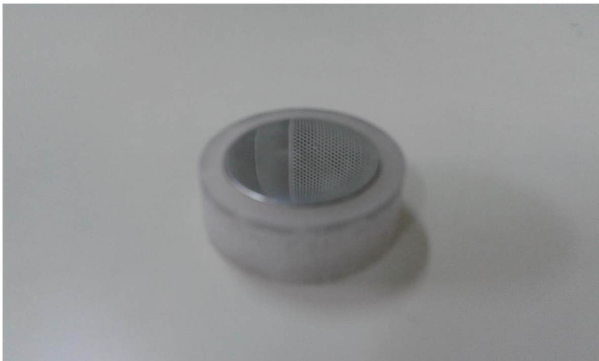
Εικόνα 3.2 Δοκίμιο χάλυβα St37 τοποθετημένο εντός της βάσεως στήριξης.
