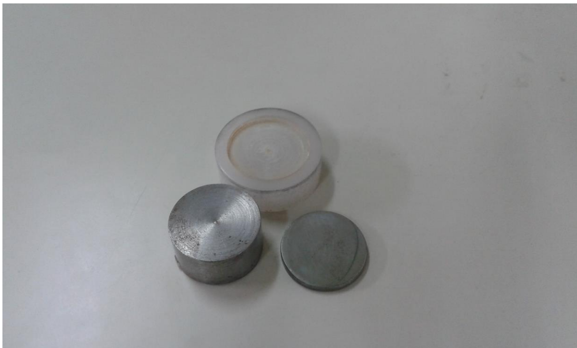
Εικόνα 3.1 Ακατέργαστο τεμάχιο, κατεργασμένο δοκίμιο και πολυμερική βάση στήριξης.
