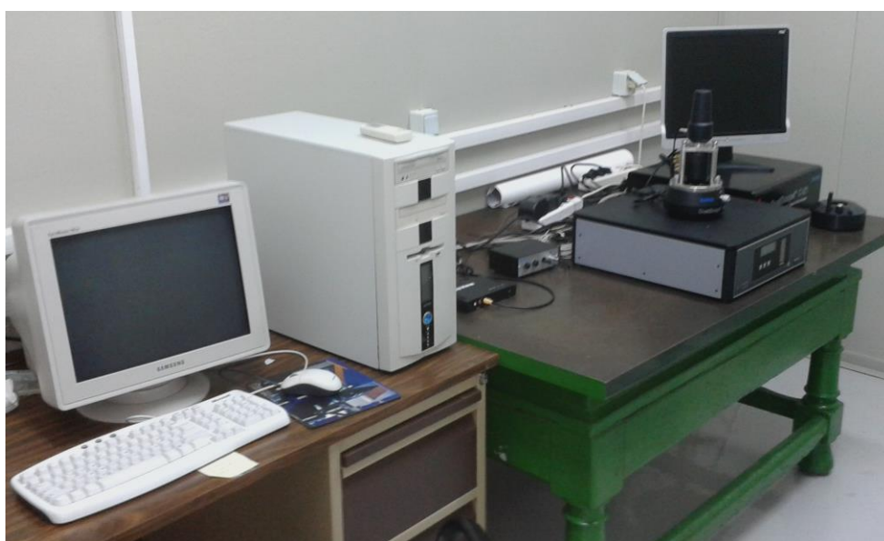
Εικόνα 3.11 Μικροσκόπιο Ατομικής Δύναμης. Τομέας Τεχνολογίας των Καταργασιών, Σχολής Μηχανολόγων Μηχανικών ΕΜΠ.
