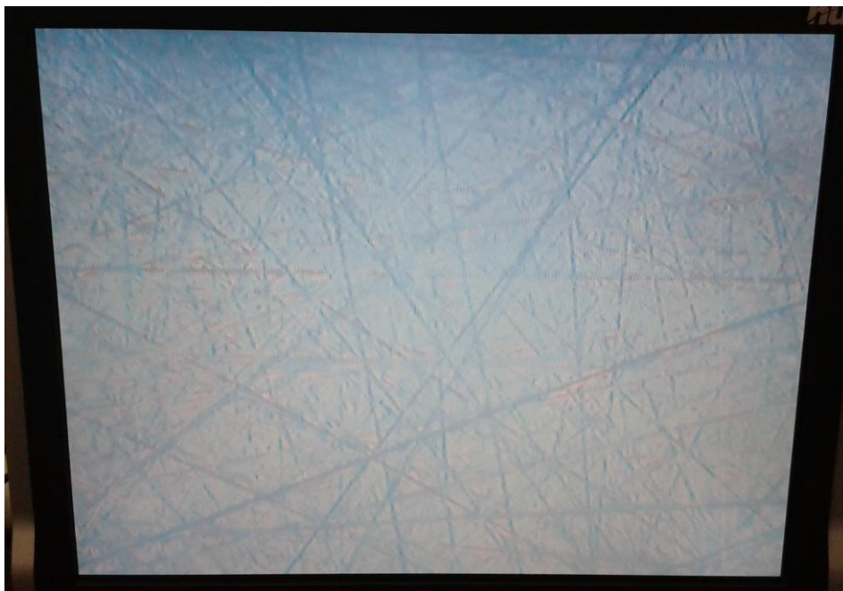
Εικόνα 4.11 Επιφάνεια δοκιμίου κατά τα πρώτα στάδια της κατεργασίας όπως γίνεται εμφανής μέσω της κάμερας CCD.
