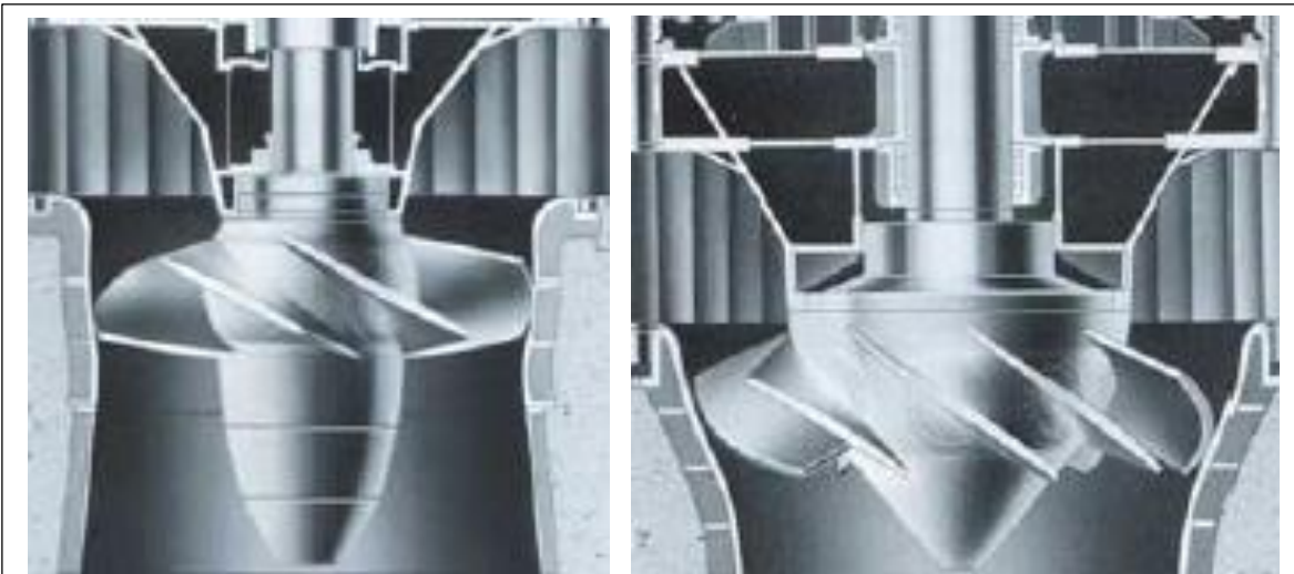
Σχήμα 2.11 Δρομέας υδροστροβίλου Karlan [αριστερά] και Deriaz [δεξιά] με σπειροειδές κέλυφος. Διακρίνονται τα ρυθμιστικά πτερύγια.
