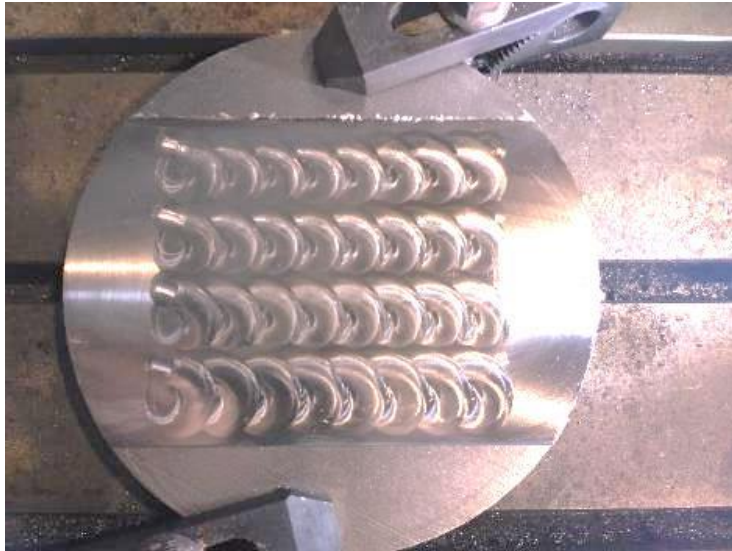
Σχήμα 7-14: Δείγμα της επιφάνειας με το πέρας της λείανσης.
