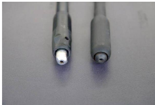
Σχήμα 4-23: Διαφορά στον μηχανισμό συγκράτησης για τις διαφορετικές επεκτατικές ντίζες.
