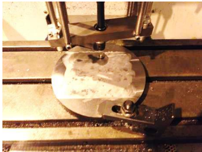
Σχήμα 7-16: Κατεργασία με μπρούτζινο δακτύλιο.
