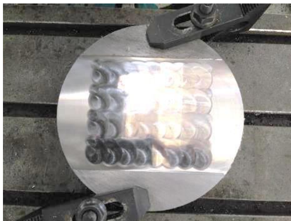
Σχήμα 7-18: Η επιφάνεια μετά τα πρώτα περάσματα με πλαστικό δακτύλιο.
