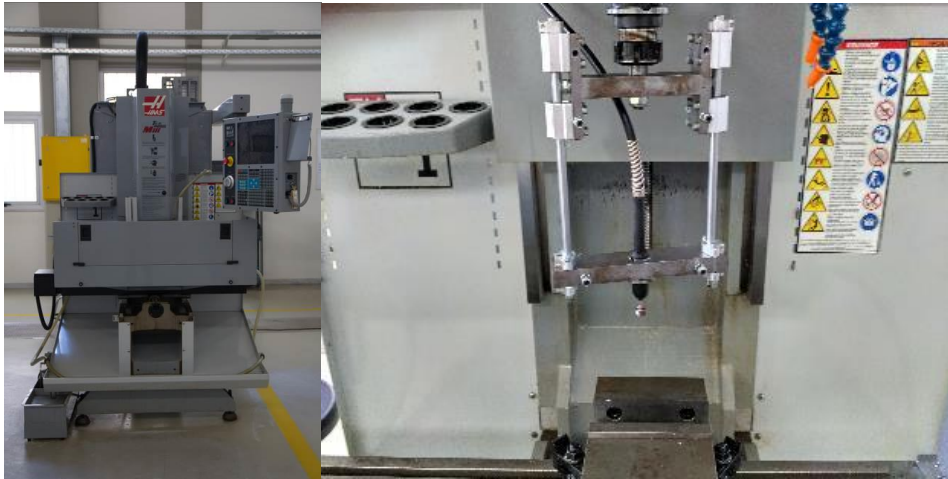
Σχήμα 4-18: Άποψη του κέντρου κατεργασιών Haas TM-1 με το σύστημα στίλβωσης.
