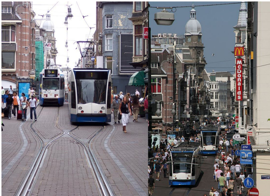
Φωτογραφία 7. Δίκτυο τραμ μονής λωρίδας με σημεία διασταυρώσεων στο Άμστερνταμ σήμερα. Η κίνηση γίνεται σε δύο ανεξάρτητες ράγες σε πολύ κοντινή απόσταση.
