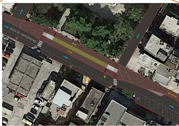
Διάγραμμα 1. Διάταξη αποκλειστικής λωρίδας διπλής κατεύθυνσης και θέσεων διασταυρώσεων.
