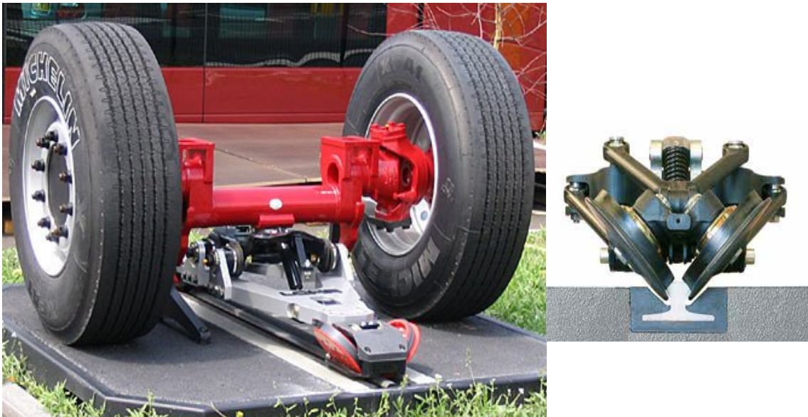
Φωτογραφία 13. Μηχανισμός μονής ράγας και ελαστικών. Εξασφαλίζει μείωση του θορύβου και μείωση ακτίνας στροφής από 25 μ. όπως ενός συμβατικού Τραμ σε μόλις 10 μ. όπως δηλαδή ενός λεωφορείου.
