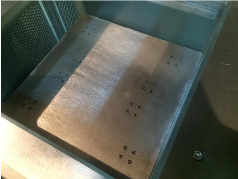
Εικόνα 27: Άνοψη του σφραγιστικής κατασκευής του χώρου εργασίας
