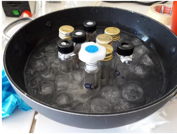
Εικόνα 18: Τα δείγματα στο παγόλουτρο κατά τον προσδιορισμό του αμύλου
