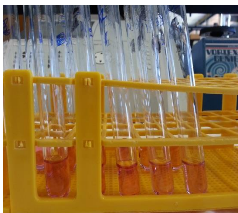
Εικόνα 17: Προσδιορισμός ελεύθερης γλυκόζης με τη μέθοδο GOD/PAP
