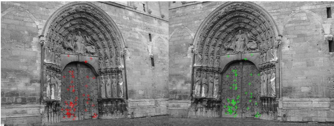
7.77. Επιπολικές εικόνες του επίγειου στερεοζεύγους εικόνων, όπου παρουσιάζονται οι τελικές ομολογίες σημείων από την εφαρμογή του τελεστή \text{MinEigen} στην αριστερή (κόκκινο χρώμα) και την δεξιά (πράσινο χρώμα) εικόνα.
