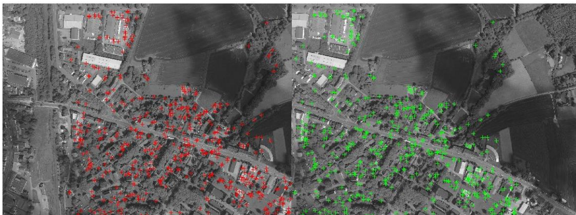
7.59. Επιτολικές εικόνες του δεύτερου στερεοζεύγους από το πεντακάμερο, όπου παρουσιάζονται οι τελικές ομολογίες σημείων από την εφαρμογή του τελεστή Mser στην αριστερή (κόκκινο χρώμα) και την δεξιά (πράσινο χρώμα) εικόνα.
