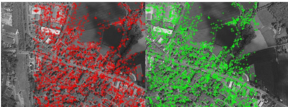
7.61. Επιπολικές εικόνες του δεύτερου στερεοζεύγους από το πεντακάμερο, όπου παρουσιάζονται οι τελικές ομολογίες σημείων από την εφαρμογή του τελεστή Sift στην αριστερή (κόκκινο χρώμα) και την δεξιά (πράσινο χρώμα) εικόνα.
