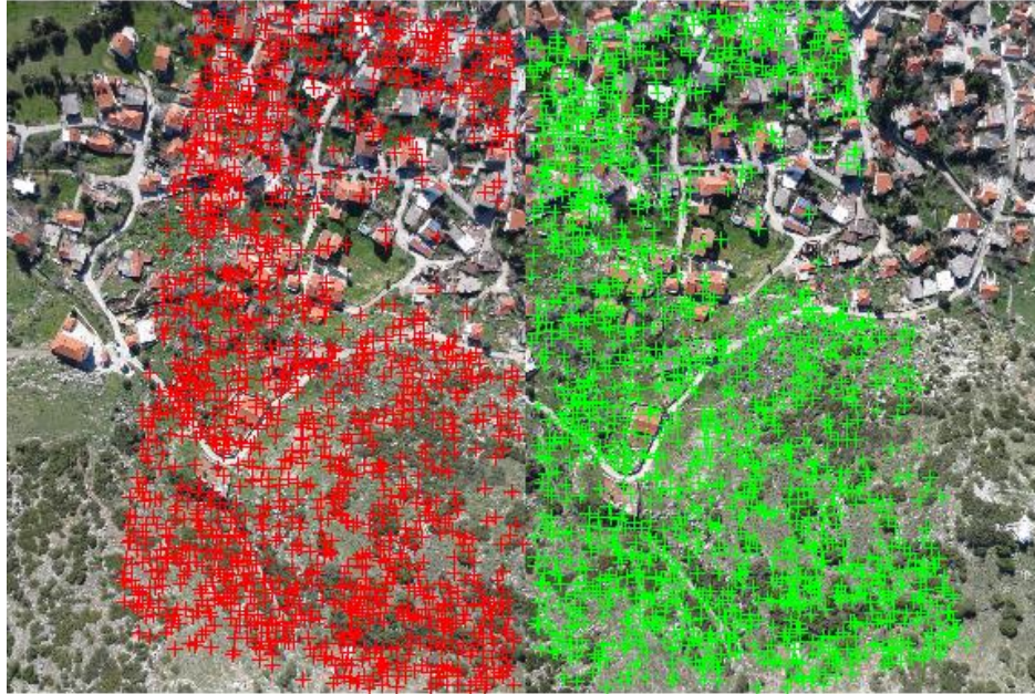
7.14. Επιπολικές εικόνες του στερεοζεύγους από τα Βίλια, όπου παρουσιάζονται οι τελικές ομολογίες σημείων από την εφαρμογή του τελεστή Sift στην αριστερή (κόκκινο χρώμα) και τη δεξιά (πράσινο χρώμα) εικόνα.
