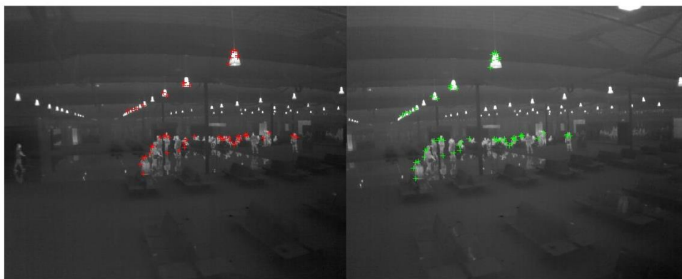
7.90. Επιπολικές εικόνες του επίγειου στερεοζεύγους εικόνων, όπου παρουσιάζονται οι τελικές ομολογίες σημείων από την εφαρμογή του τελεστή Fast στην αριστερή (κόκκινο χρώμα) και την δεξιά (πράσινο χρώμα) εικόνα.
