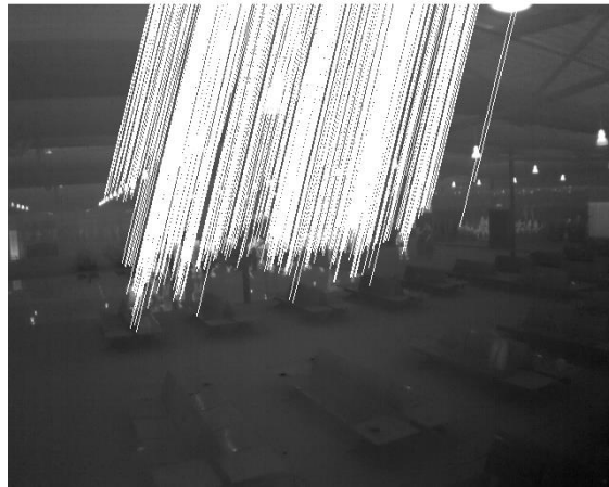
7.100. Επιπολικές εικόνες του στερεοζεύγους των θερμικών εικόνων, όπου παρουσιάζονται οι τελικές ομολογίες των σημείων όπως προέκυψαν από την εφαρμογή του τελεστή Asift, τόσο σε κατακόρυφη (πρώτη εικόνα) όσο και σε οριζόντια (δεύτερη εικόνα) διάταξη.
