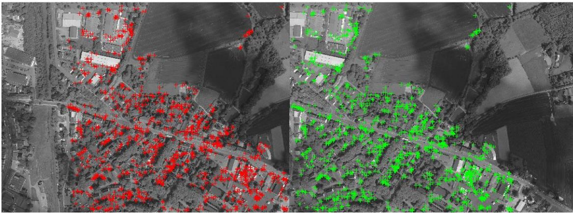
7.53. Επιτολικές εικόνες του δεύτερου στερεοζεύγους από το πεντακάμερο, όπου παρουσιάζονται οι τελικές ομολογίες σημείων από την εφαρμογή του τελεστή Fast στην αριστερή (κόκκινο χρώμα) και τη δεξιά (πράσινο χρώμα) εικόνα.
