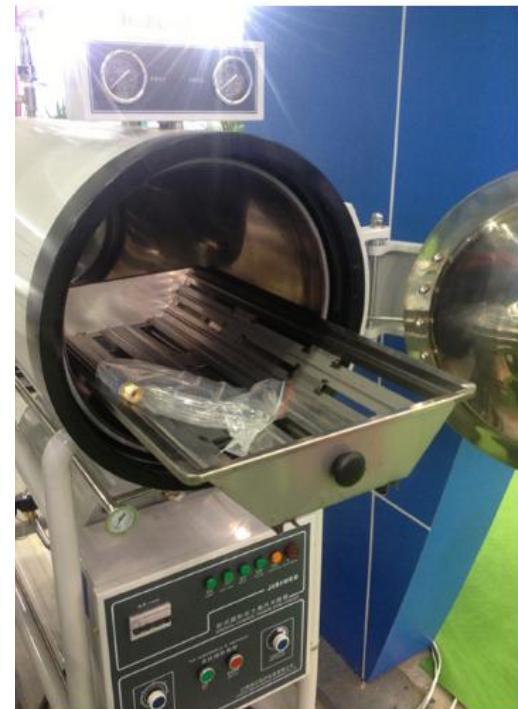
Σχήμα 1.2.2-1 Παλιός κλίβανος θερμού ατμού (autoclave) [15]
