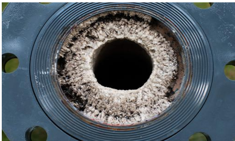
Σχήμα 9: Επικαθίσεις στρουβίτη σε σωλήνα
