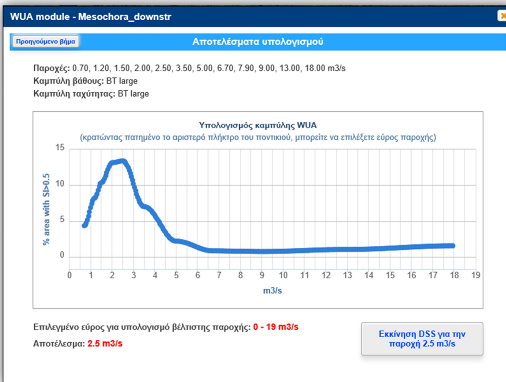
Εικόνα 3.1-3. Σταθμισμένη Κατάλληλη Έκταση για τη μεγάλη πέστροφα με την εφαρμογή του Υδρο-οικολογικού εργαλείου ECOFLOW στην περιοχή μελέτης
