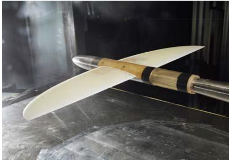
Σχήμα: Το πειραματικό μοντέλο της πτέρυγας baseline
