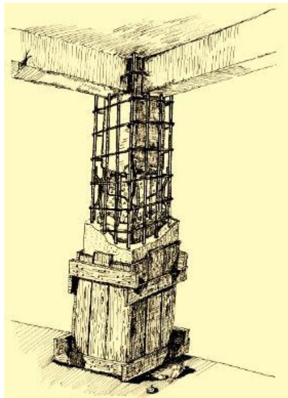
Σχήμα 5.3 Κατασκευή μανδύα από οπλισμένο σκυρόδεμα
