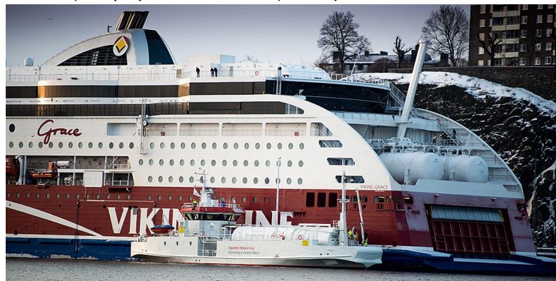
Εικόνα 1 Ανεφοδιασμός LNG με Πλοίο Ανεφοδιασμού Πηγή: http://hhpinsight.com/
