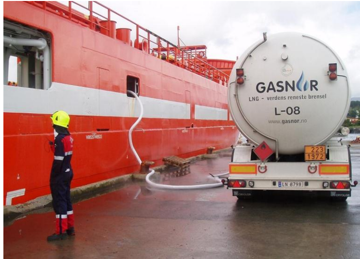
Εικόνα 2 Ανεφοδιασμός Καυσίμου LNG από Φορτηγό [15]
