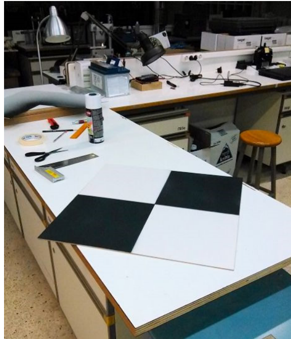
Ένας από τους φωτοσταθερούς στόχους που κατασκευάστηκαν
