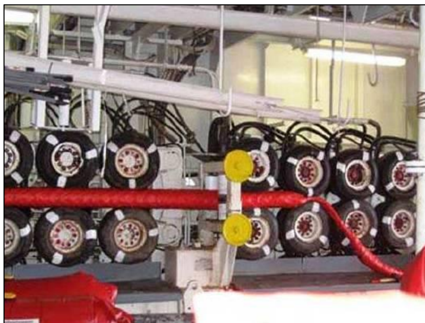
Εικόνα 2-16: Εντατήρας καλωδίου με οκτώ ζεύγη τροχών που συγκρατούν το τελείωμα του προπορευόμενου καλωδίου.
