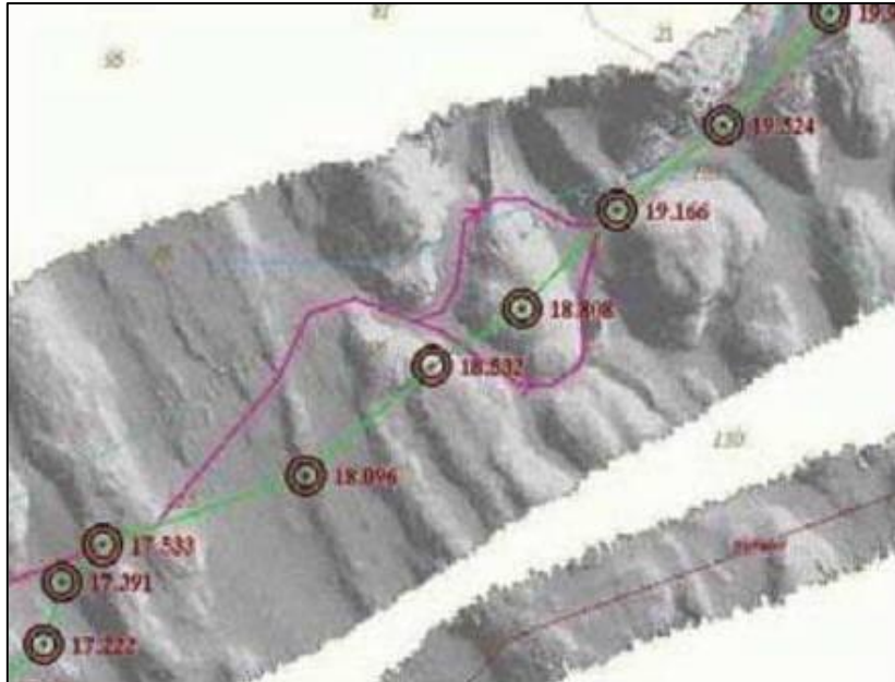
Εικόνα 2-19: Η αρχικά σχεδιασμένη διαδρομή (ευθεία γραμμή) θα συνεπαγόταν πολλές διασταυρώσεις με κορυφογραμμές και κοιλάδες με τον κίνδυνο των μεγάλων ανοιγμάτων. Η λεπτομερής έρευνα της διαδρομής επέτρεψε την πόντιση του καλωδίου κατά μήκος της καμπύλης γραμμής, αποφεύγοντας τους κυματισμούς (Berthelsen, 2008).
