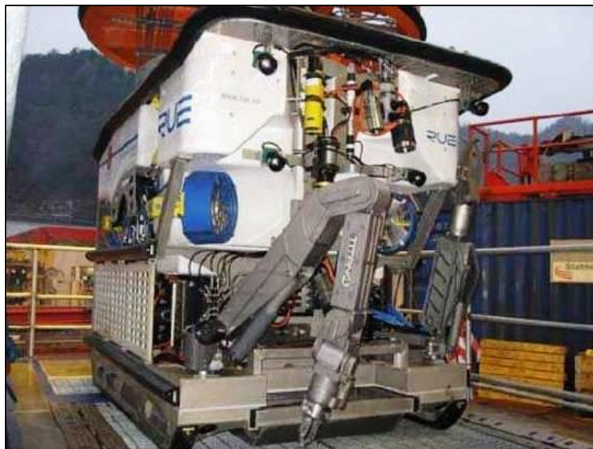
Εικόνα 2-18: ROV με βραχίονες συγκράτησης και κάμερες.
