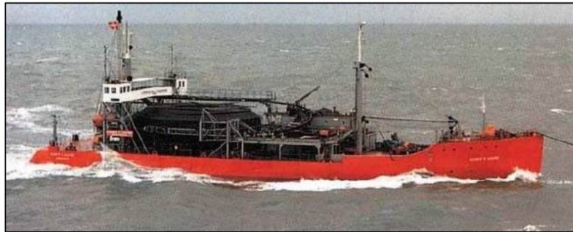
Εικόνα 2-11: Ρυμουλκούμενη φορηγίδα πόντισης καλωδίου “H.P. Lading” με περιστρεφόμενη τράπεζα.
