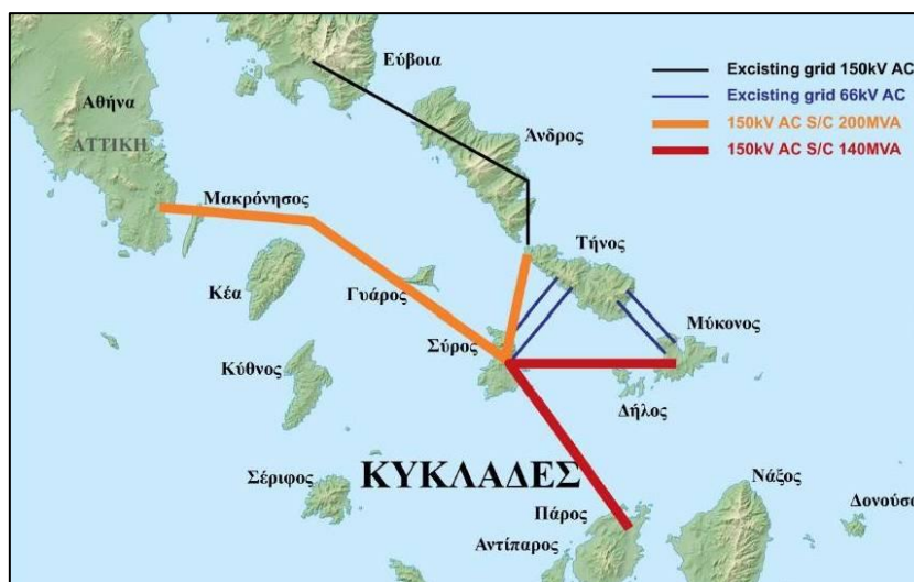
Εικόνα 2-1: Ο χάρτης της ηλεκτρικής διασύνδεσης των Κυκλάδων (ΑΔΜΗΕ, 2014).
