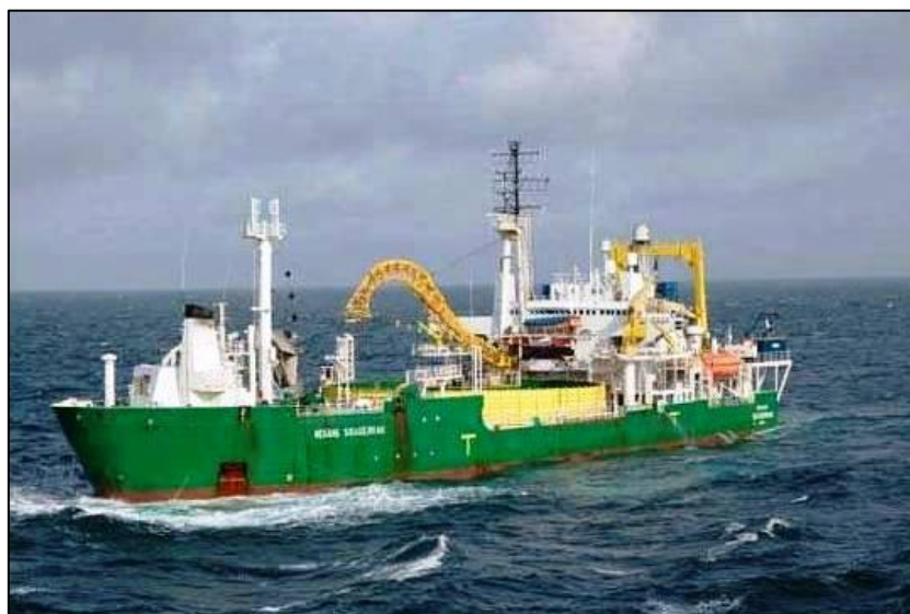
Εικόνα 2-8: C/S "Skagerrak" DP2 πλοίο με περιστρεφόμενη τράπεζα άνω των 6000 t, κατάλληλο για όλα τα είδη εγκατάστασης και επισκευής καλωδίων.
