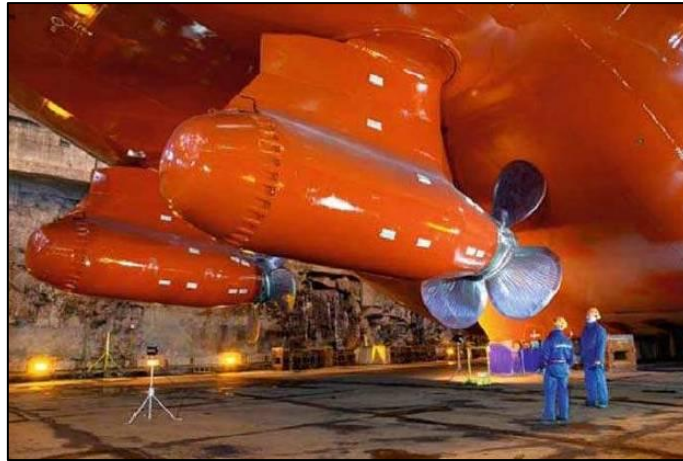
Εικόνα 2-15: Ατρακτοειδείς προπέλες. (ABB, Φινλανδία)
