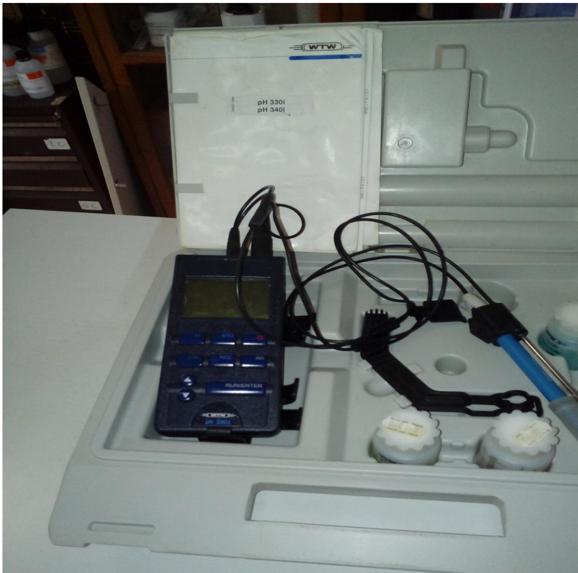
Εικόνα 7.1.4 : Όργανο μέτρησης pH και Θερμοκρασίας
