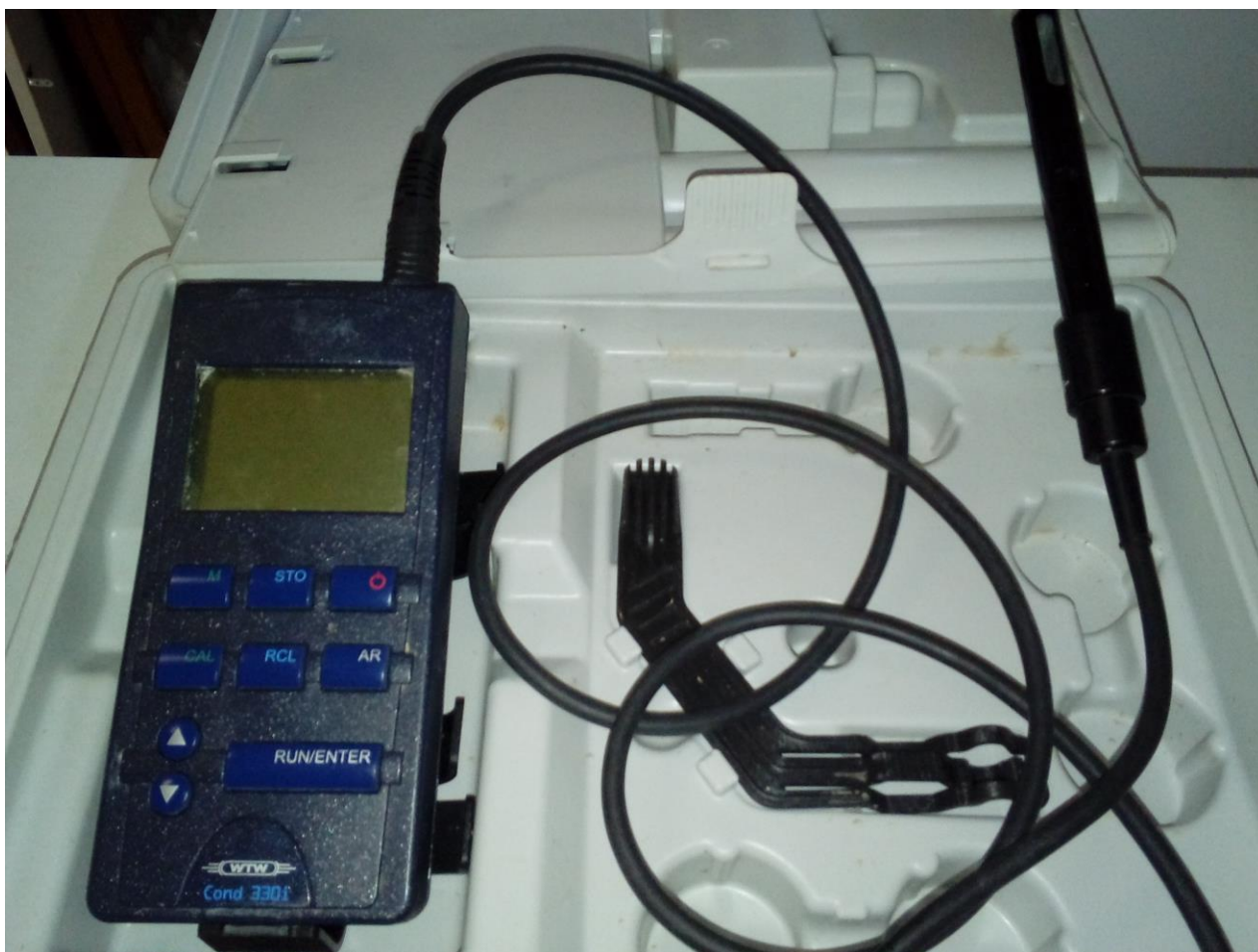
Εικόνα 7.1.5 : Όργανο μέτρησης Ειδικής Ηλεκτρικής Αγωγιμότητας και Θερμοκρασίας
