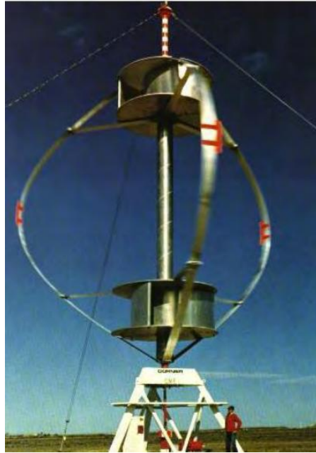
Σχήμα 1.12: Ανεμογεννήτρια κατακορύφου άξονα
