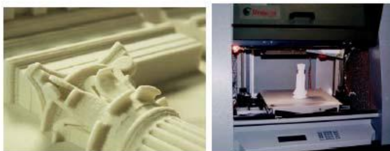
Εικόνα 4. Συσκευή εκτύπωσης με εναπόθεση υλικού (δεξιά) και δείγμα εκτύπωσης (αριστερά)
