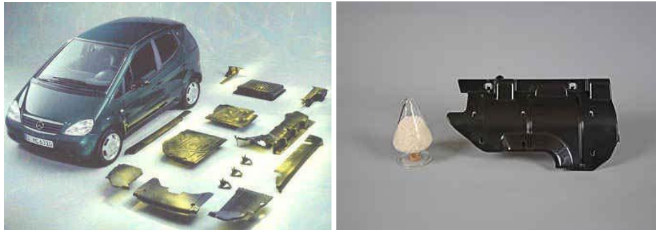
Εικόνα 2.12: Χρήση του PLA σε εξαστήματα αυτοκινήτου
