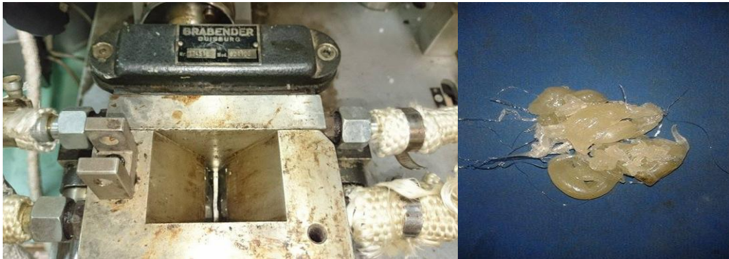
Εικόνα 5.3: Παράθυρο ανάδευσης του αναμεικτήρα και η μάζα με τη μορφή που εξάγεται μετά την ανάμιξη
