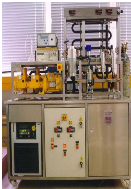
Εικ. 2.3: Η συσκευή υπερκρίσιμης εκχύλισης SFE 500 (SEPAREX)
