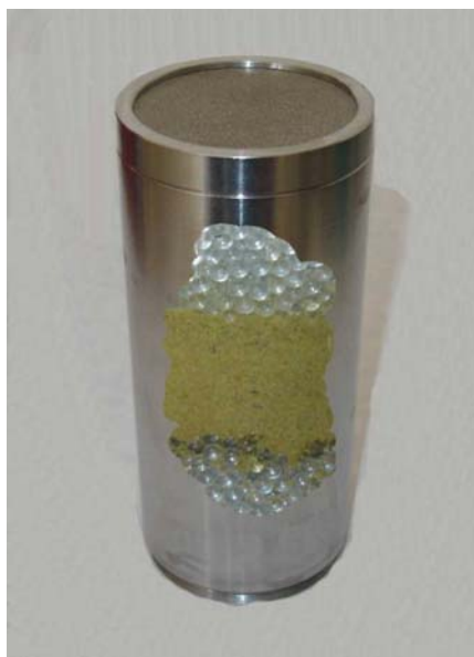
Εικ. 2.5: Απεικόνιση του δείγματος στο εσωτερικό του εκχυλιστήρα κατά τη διάρκεια των εκχυλίσεων
