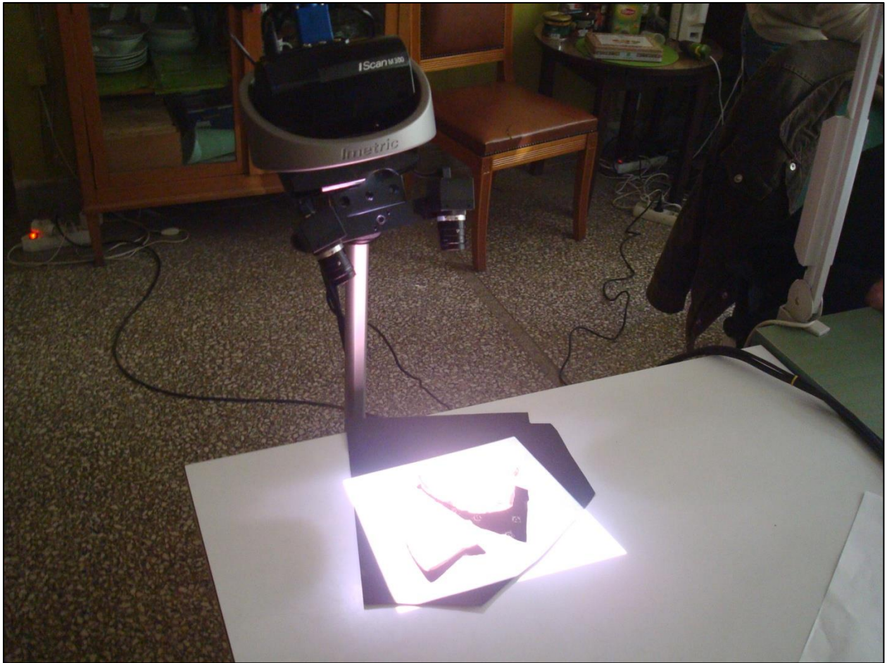
Εικόνα 17 - Στιγμιότυπο χρήσης του τρισδιάστατου σαρωτή για την ψηφιοποίηση θραυσμάτων
