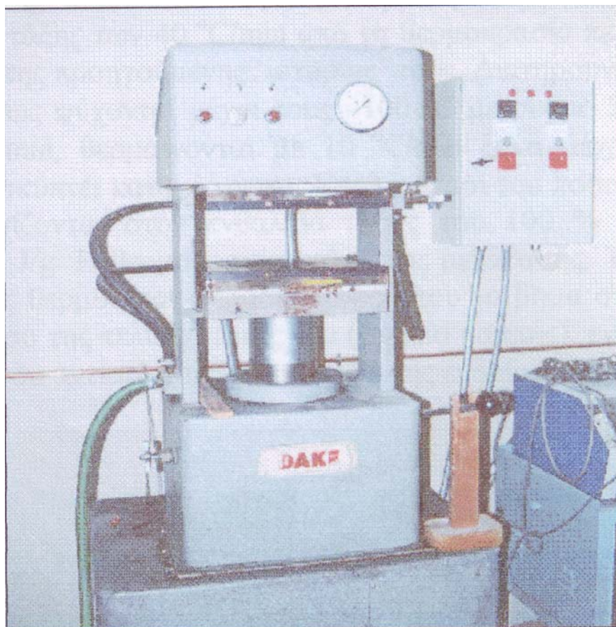
Εικόνα 5.2 Θερμοπρέσα για τη μόρφωση με συμπίεση των υλικών
