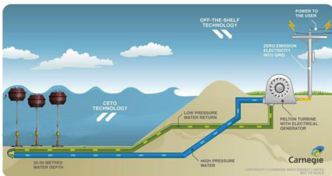
Σχήμα 2.9: Fully submerged point absorber (Πηγή: Carnegie, CETO design, Australia)
