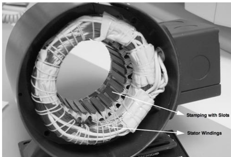
Σχήμα 3.6 Στάτης σύγχρονης μηχανής μόνιμου μαγνήτη
