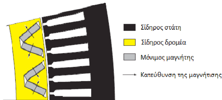
Σχήμα 3.13 Τομή μηχανής μόνιμων μαγνητών σε σχηματισμό V
