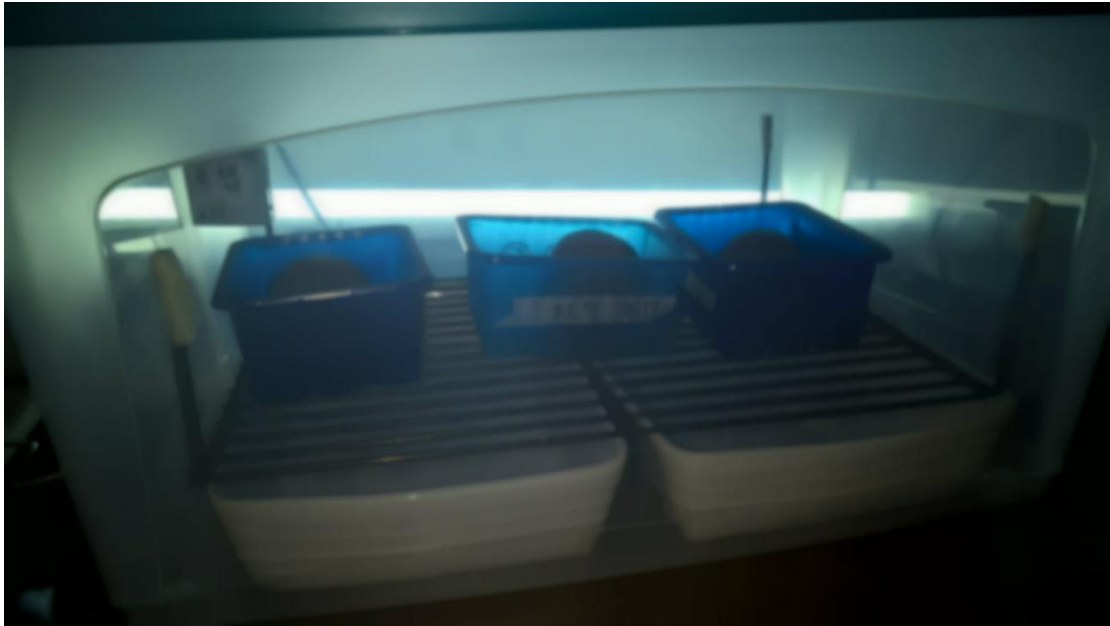
Εικόνα 3.1: Περιέκτης και δείγματα σε ειδικές θήκες. Κάτω από τη σχάρα, βρίσκονται τα υπέρκορα διαλύματα αλάτων για τη ρύθμιση της σχετικής υγρασίας του αέρα συντήρησης.
