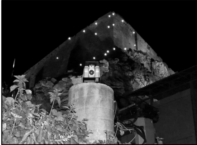
Εικόνα 1.2: Προσδιορισμός παραμορφώσεων με ολοκληρωμένο γεωδαιτικό σταθμό
