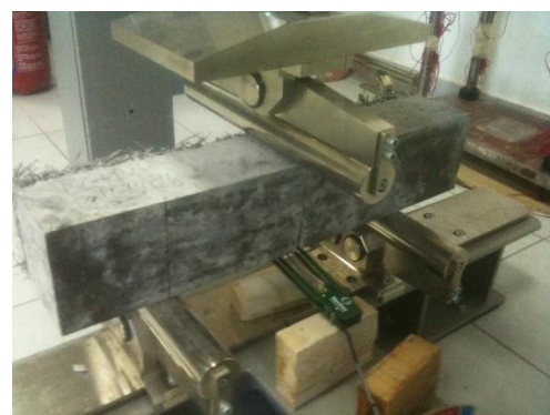
Σχήμα 2.7 Γεωμετρία, διάταξη και εκτέλεση της δοκιμής κάμψης τριών σημείων.
