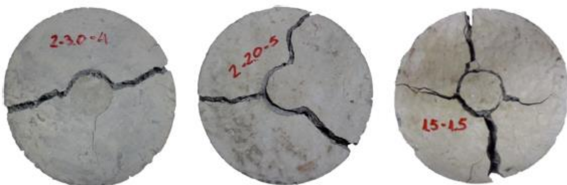
Σχήμα 2.5 Τυπικές μορφές αστοχίας κατά τη δοκιμή Barcelona [18].
