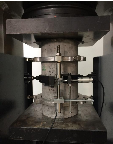
Σχήμα 2.2 Διάταξη και αστοχία κατά τη δοκιμή θλίψης για τον προσδιορισμό E και \nu .
