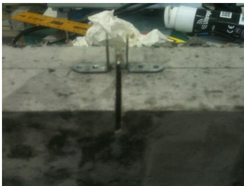
Σχήμα 2.7 Γεωμετρία, διάταξη και εκτέλεση της δοκιμής κάμψης τριών σημείων.
