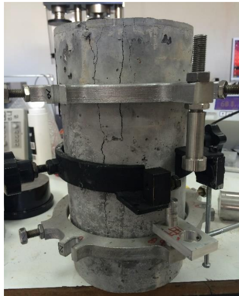
Σχήμα 2.2 Διάταξη και αστοχία κατά τη δοκιμή θλίψης για τον προσδιορισμό E και \nu .
