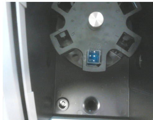
Σχήμα 7: Φασματόμετρο UV-VIS HITACHI 5100.
