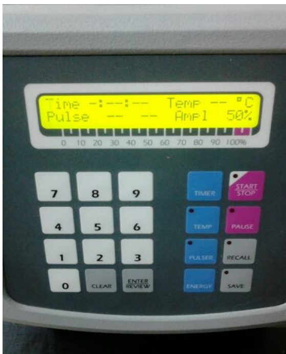
Σχήμα 16: Συσκευή ελέγχου παλμών και έντασης και διάταξη ηχοβόλησης με το ηχόδιο να φαίνεται μπροστά και το λουτρό από πίσω καθώς και το ανεμιστηράκι για να μην υπερθερμαίνεται το ηχόδιο.
