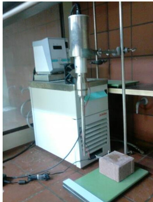
Σχήμα 16: Συσκευή ελέγχου παλμών και έντασης και διάταξη ηχοβόλησης με το ηχόδιο να φαίνεται μπροστά και το λουτρό από πίσω καθώς και το ανεμιστηράκι για να μην υπερθερμαίνεται το ηχόδιο.
