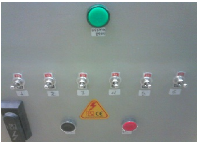
Σχήμα 10 : Λεπτομέρειες διάταξης φωτοκατάλυσης, εσωτερική όψη (πάνω) και σύστημα ελέγχου λαμπτήρων.
