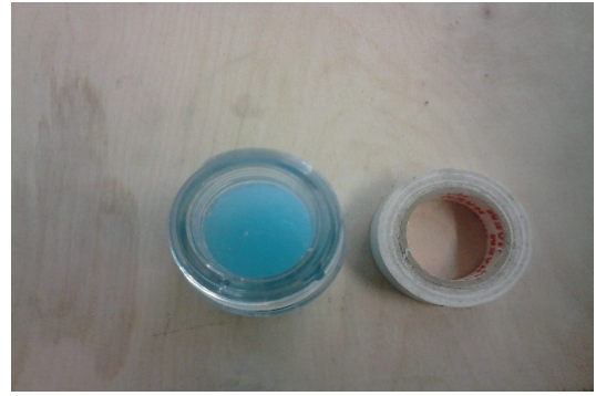
Σχήμα 13: Μεταβολή χρώματος του μεθυλενίου μετά από λουτρό υπερήχων, ανάδευση και φωτοβόληση.
