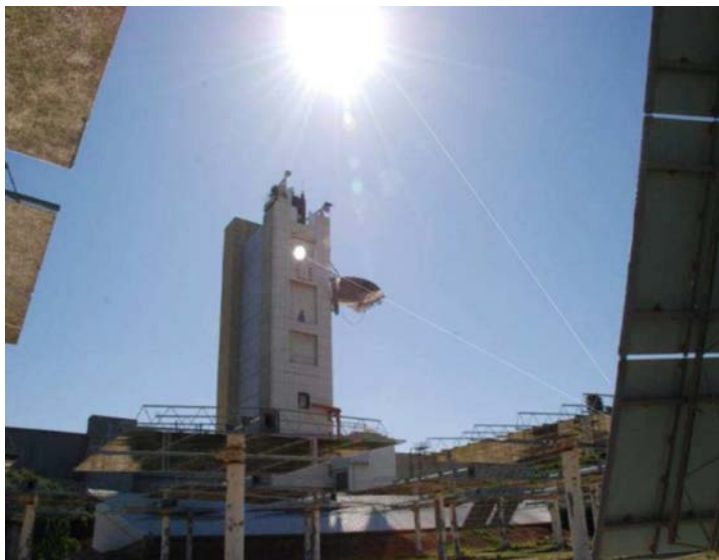
Σχήμα 3.19. Πειραματική διάταξη υβριδικού αεριοστροβίλου (Dickey, 2011)
