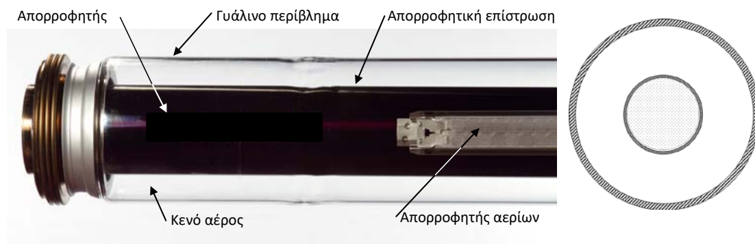
Σχήμα 2.8. Παράδειγμα δέκτη κοίλου κατόπτρου (SIEMENS)
