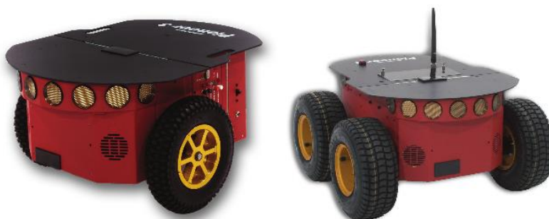
Εικόνα 1.15 - Pioneer 3-DX (2-τροχοί και τροχός-caster) & Pioneer 3-AT (4-τροχοί)
