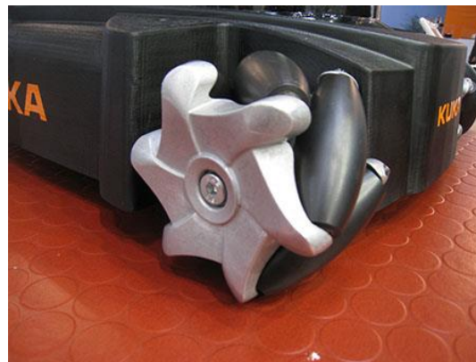
Εικόνα 3.2 – Τροχοί του kuka youBot / swedish wheels
