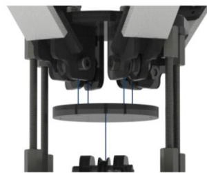
Εικόνα 3.6 – Διαφορικός μηχανισμός υποεπενεργούμενου χεριού
