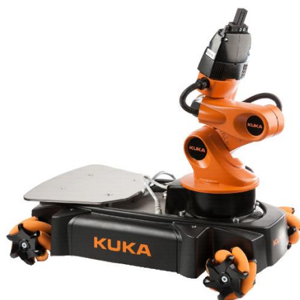
Εικόνα 3.4 – Ρομποτικό σύστημα πλατφόρμας-βραχίονα
