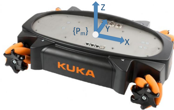
Εικόνα 3.1 – Σύστημα συντεταγμένων τηλεχειριζόμενου ρομπότ
