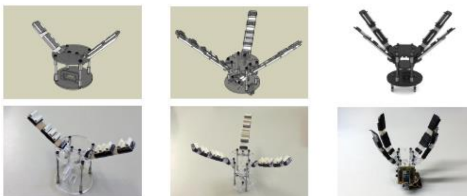
Εικόνα 1.7 - Υποεπενεργούμενο χέρι χαμηλού κόστους με 2 , 3 ή 4 δάχτυλα
