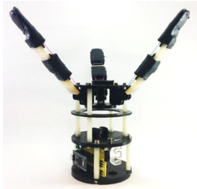
Εικόνα 3.5 – Υποεπενεργούμενο χέρι / Ακροδέκτης ρομποτικού-συστήματος
