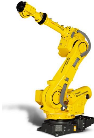
Εικόνα 1.12 - Υδραυλικός ρομποτικός βραχίονας βιομηχανικού τύπου, Fanuc R-2000 / 6-DoFs
