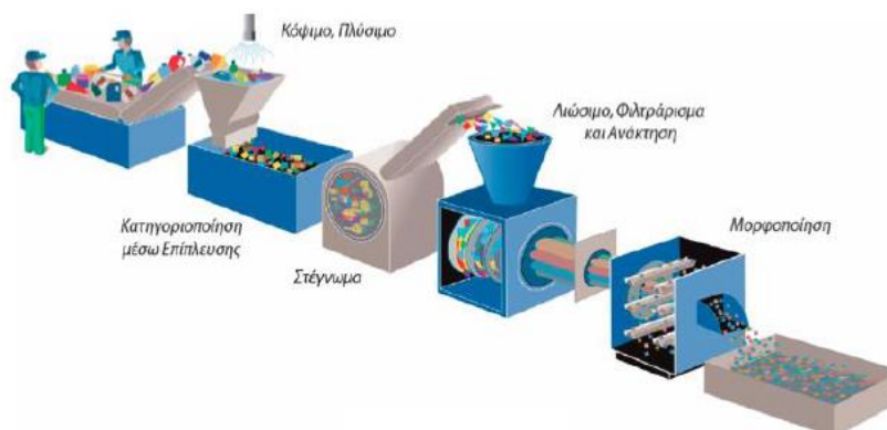
Εικόνα 2.1: Στάδια δευτερογενούς ανακύκλωσης (με διαχωρισμό προσμίξεων) [5]
