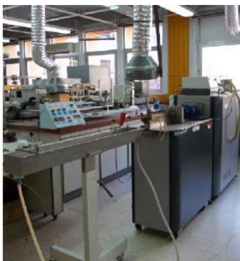
Εικόνα 6.1: Δικόχλιος ομόστροφος εκβολέας Haake (Rheomex PTW16p, Thermo Fischer Scientific Inc.)
