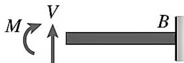
Εικόνα 2.4: Τομή mn , διατμητικές δυνάμεις V και καμπτικές ροπές M
