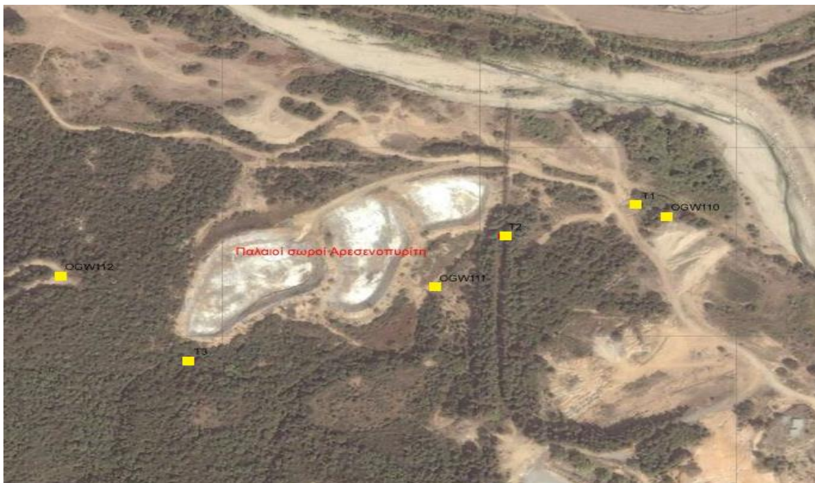
Εικόνα 6.5 : Θέσεις δικτύου παρακολούθησης περιβαλλοντικών παραμέτρων στην άμεση περιοχή των προς αποκατάσταση παλαιών χώρων απόθεσης αρσενοπυριτή Ολυμπιάδας
