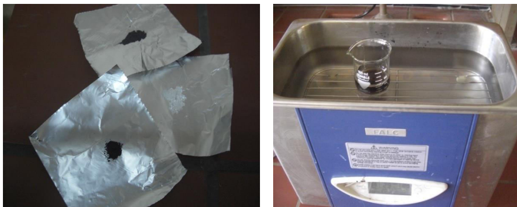
Εικόνα 6.6: (a) Ζύγιση και συλλογή των απαραίτητων ποσοτήτων GO, άλατος του Zn και σκόνης Se και (b) Διάλυση της ποσότητας GO σε EG και τοποθέτηση σε λουτρό υπερήχων για την παρασκευή του διαλύματος A.
