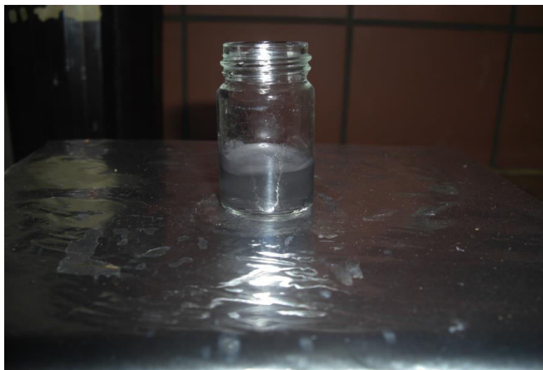
Εικόνα 6.12: Το διάλυμα Β (σκόνη Se, 0,5 mL EG και HNO 3 Μ) υπό ανάδευση σε μαγνητική πλάκα.
