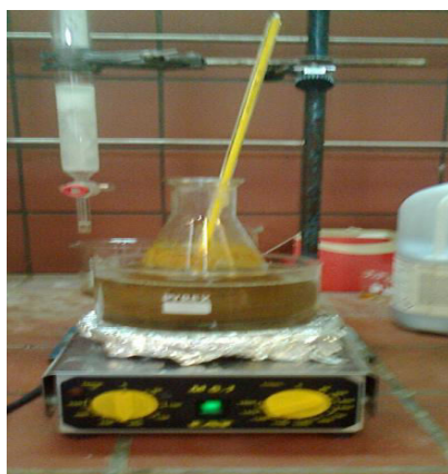
Εικόνα 6.4: Το διάλυμα υπό ανάδευση μετά την προσθήκη του \text{H}_2\text{O}_2 30%, όπου απέκτησε φωτεινό κίτρινο χρώμα.
