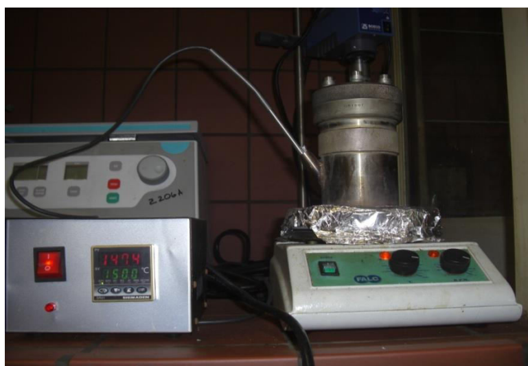
Εικόνα 6.13: Πειραματική διάταξη διαλυτοθερμικής σύνθεσης, το αυτόκλειστο ανοξείδωτο χάλυβα συνδεδεμένο με το θερμοστοιχείο.
