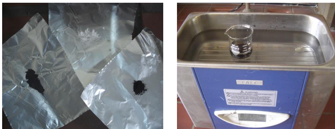
Εικόνα 6.11: (a) Ζύγιση και συλλογή των απαραίτητων ποσοτήτων GO, άλατος του Zn και σκόνης Se και (b) Διάλυση της ποσότητας GO σε EG και τοποθέτηση σε λουτρό υπερήχων για την παρασκευή του διαλύματος Α.
