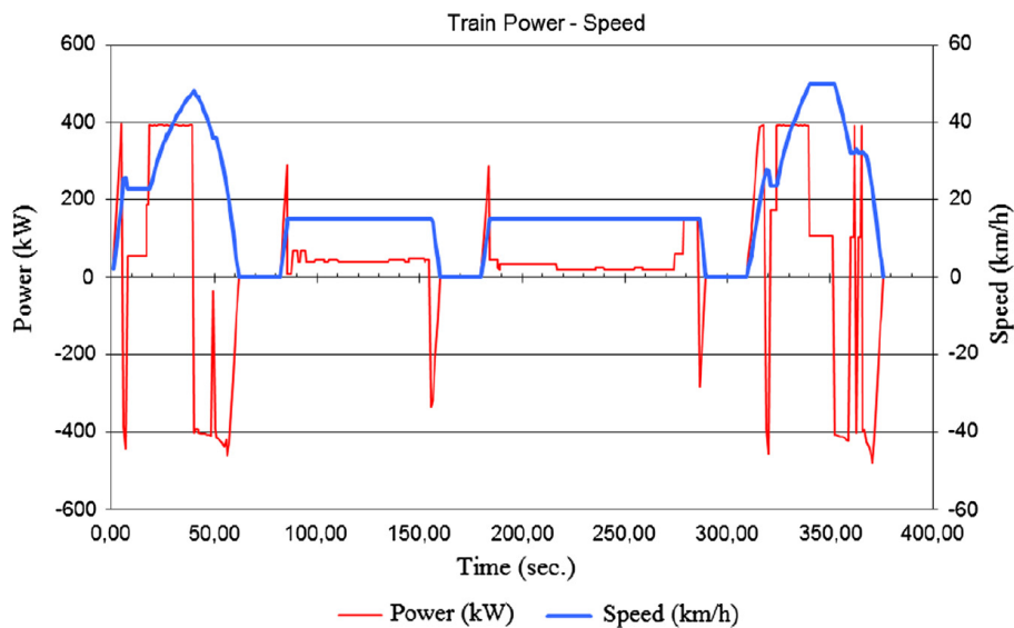
Σχήμα 3.2: Διάγραμμα ισχύος και ταχύτητας για τον κύκλο λειτουργίας 4 διαδοχικών στάσεων νέος υβριδικού τρένου
